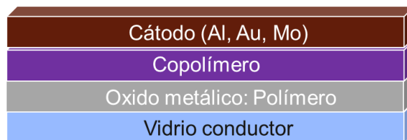
Figura 5. Estructura de las celdas de heterounión (BHJ).
