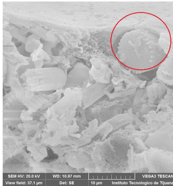
Figura 52. Imagen de SEM de sección transversal, en el círculo se observa el rompimiento de la capa fina de la superficie por efecto de una partícula de tierras diatomeas. Voltaje de aceleración 20 KV, escala 10 \mu\text{m} .
