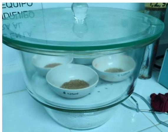
Ilustración 22. Desecador para muestras calcinadas
