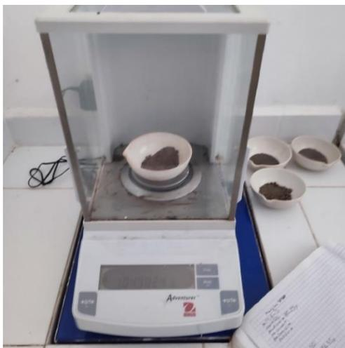
Ilustración 23. Balanza analítica para peso de muestras y muestras calcinadas
