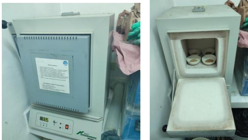
Ilustración 21. Mufla para el método de calcinación de materia orgánica
