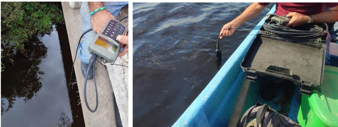
Ilustración 18. Utilización de Multiparamétrico para análisis de agua
