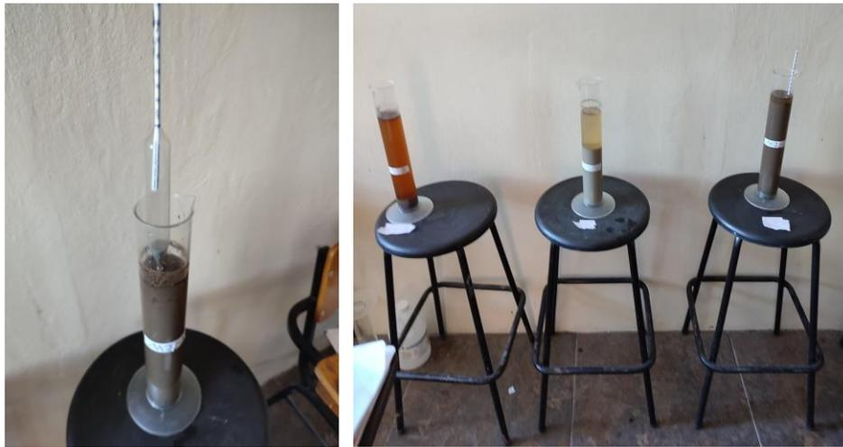
Ilustración 13. Lecturas de Bouyoucos con hidrómetro
