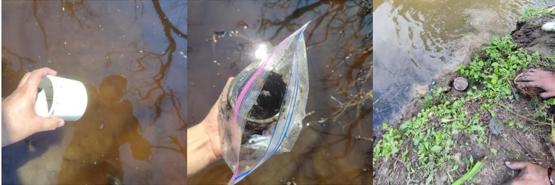
Ilustración 20. Determinación de densidad aparente con anillo de 3 pulgadas
