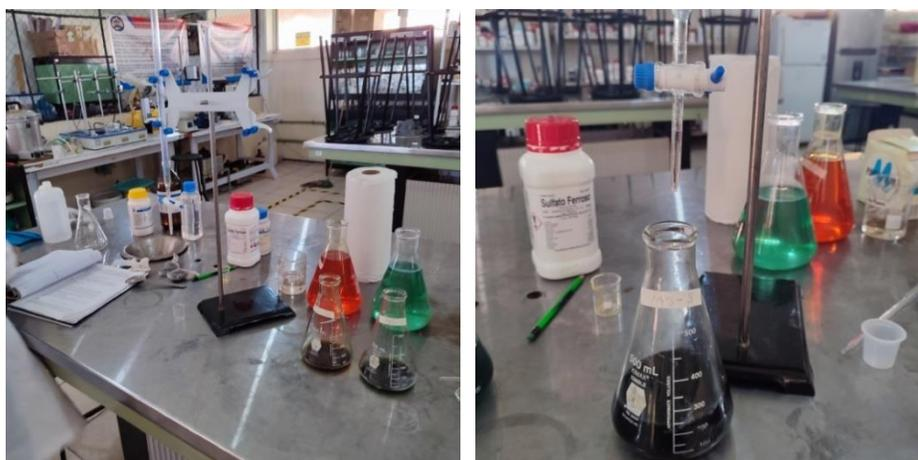
Ilustración 16. Materiales para la determinación de materia orgánica por el método de Walkley y Black
