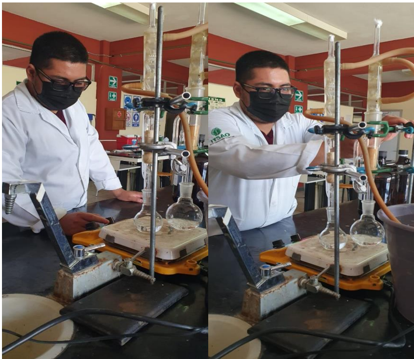
Figura 37. Determinación de grasa al pozol A-7573 y nativo.
