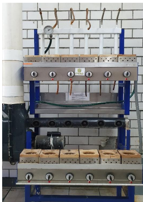
Figura 17. Kjeldahl combinado (Marca: TECNI-LAB, Modelo: K6U-COMB) para la determinación de proteína.
