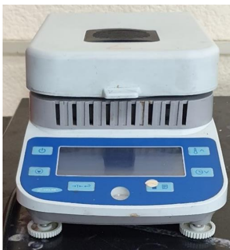
Figura 15. Termobalanza (Marca: VELAB, Modelo: VE-50-5) para la determinación de humedad.
