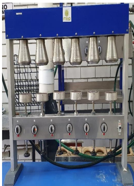
Figura 18. Extractor de fibra cruda 6 unidades (Marca: Tecni-Lab, Modelo: FC-6U) para la determinación de fibra cruda.
