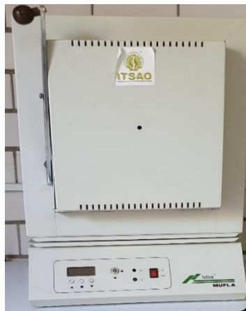
Figura 16. Mufla (Marca: Felisa, Modelo: FE-360) para la determinación de ceniza.
