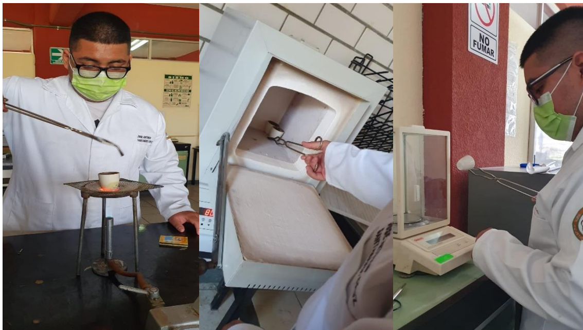
Figura 34. Determinación de ceniza al pozol A-7573 y nativo.
