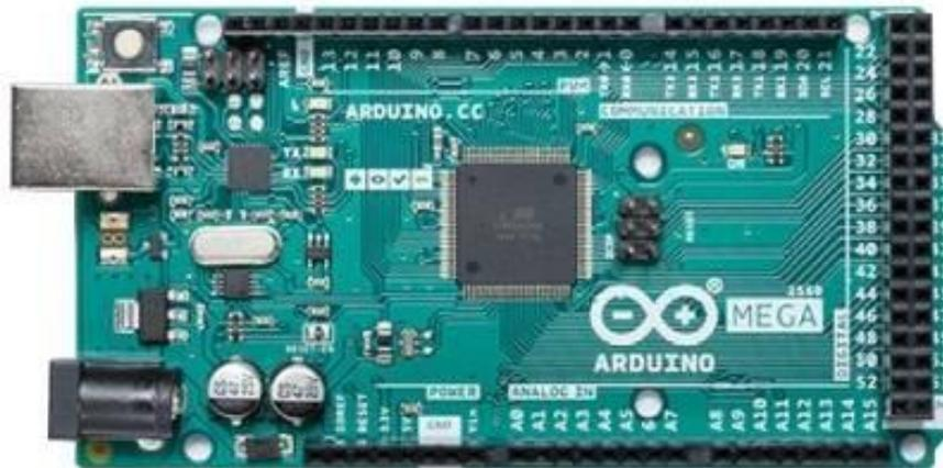
Figura 2.7. Placa Arduino Mega 2560
