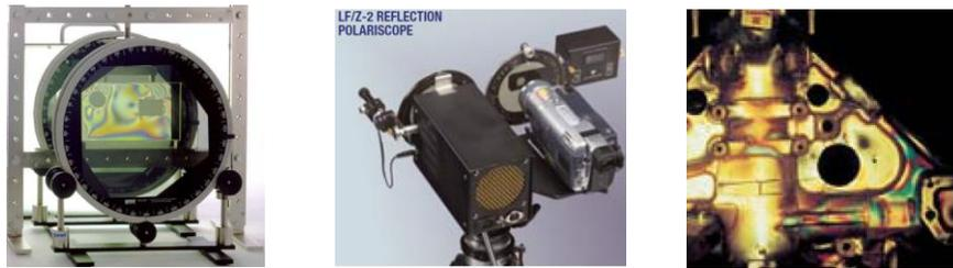
a) Polariscopio de transmisión
