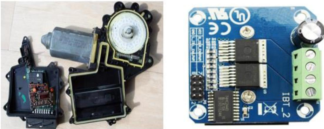
Figura 2.12.- Motorreductor del tipo elevallunas y puente H BTS7960.
