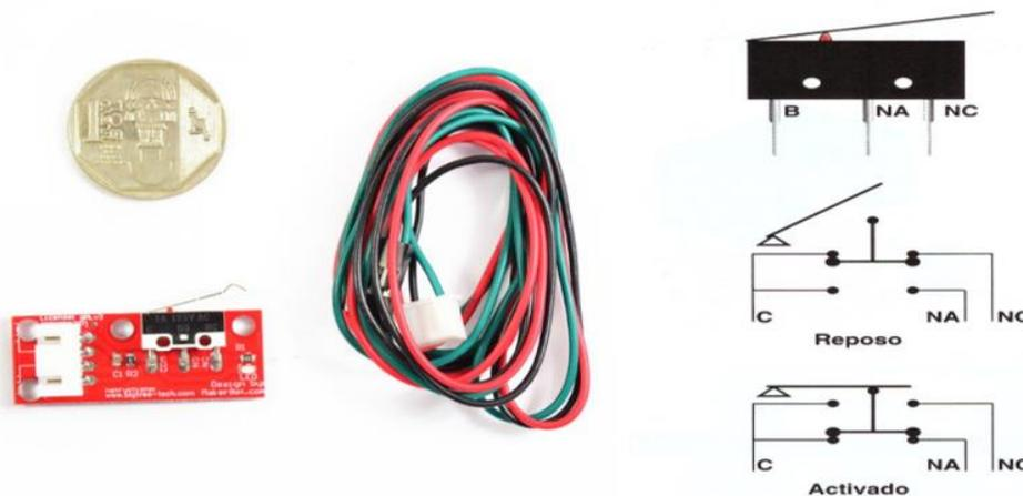
Figura 2.11. - Microinterruptor SEN-FDCM y funcionamiento.
