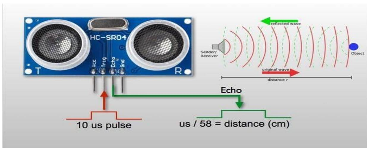
Figura 2.10. - Aplicación del sensor HC-SR04 en la detección de objetos.
