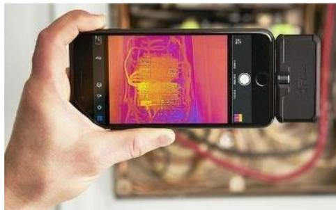
Figura 2.2: Cámara termográfica FLIR ONE PRO FLIR Systems. [12]
