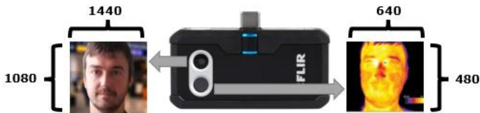
Figura 4.3: Captura de imágenes usando la cámara termográfica FLIR ONE Pro. (Diseño propio)
