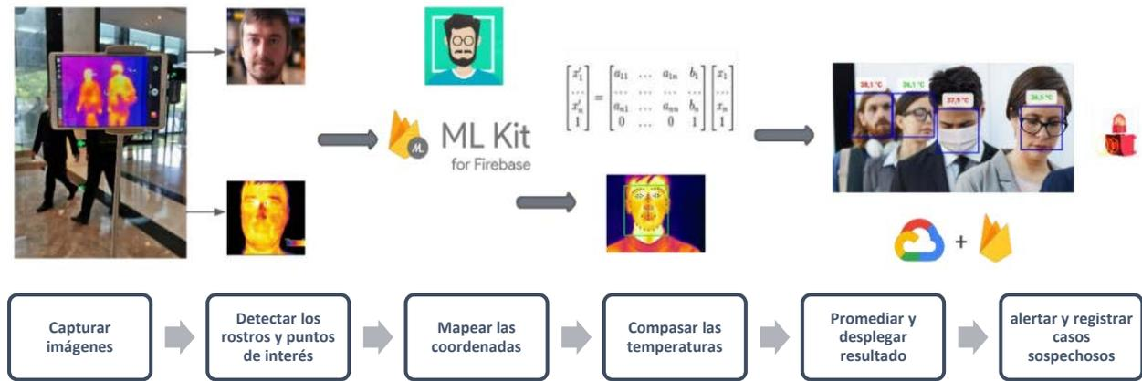
Figura 4.2: Diagrama general de la lógica de funcionamiento del sistema. (Diseño propio)
