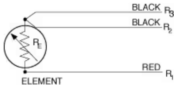
Figura 0.5.- Esquemático de RTD de 3 cables (OMEGA, 2023b)
