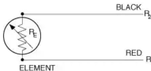
Figura 0.4.- Esquemático de RTD de 2 cables (OMEGA, 2023b)
