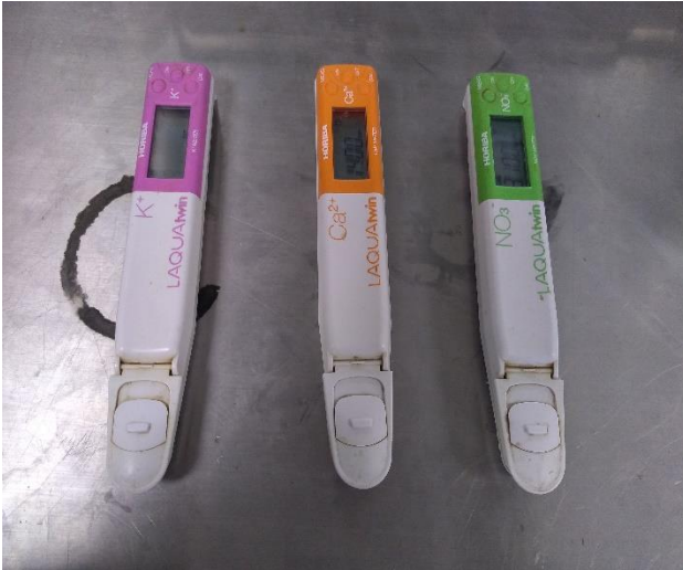
Figura No.3 Medición de K,Ca, No.my extracción de muestra con bomba
