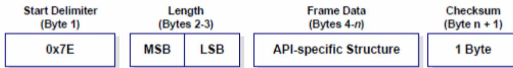
El primer byte 0x7E indica el comienzo de la trama. Los dos bytes siguientes indican solamente la longitud de la trama de Datos (Data Frame) (es decir, toda la trama sin contar ni el byte 0x7E, ni el largo-Length, ni el byte Checksum). La estructura API que viene después se compone según veamos en la figura:
