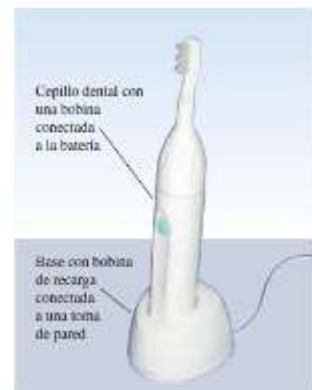
Figura 195. Figura 30.2 Este cepillo dental eléctrico usa la inductancia mutua. La base contiene una bobina a la que se suministra corriente alterna desde una toma de pared. Esta corriente variable induce una fem en una bobina en el interior del cuerpo del cepillo, la cual se utiliza para recargar la batería de este último.
