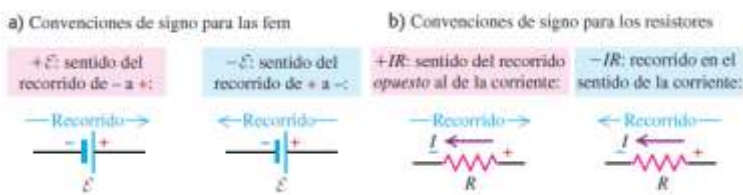
Figura 116 Figura 26.8 Uso de las convenciones de signos cuando se aplica la regla de Kirchhoff de las espiras. En cada parte de la figura "Recorrido" es el sentido en que imaginamos ir alrededor de la espira que no necesariamente es el sentido de la corriente
