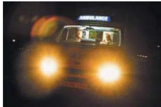
Figura 105 Los faros de un automóvil están conectados en paralelo. De ahí que cada uno esté expuesto a toda la diferencia de potencial suministrada por el sistema eléctrico del vehículo, lo que da el máximo brillo. Otra ventaja es si un faro se funde, el otro sigue funcionando (vea ejemplo 2)
