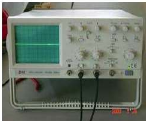
Parte frontal de un osciloscopio EZ digital modelo os-5020 de 20mhz funcionando
