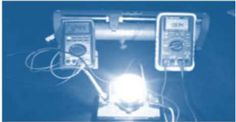
Figura 120, ilustración de la medición de la corriente y el voltaje de la energía eléctrica.
