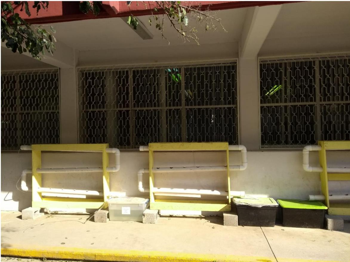
**Figura 1.2** Arreglo hidropónico para evaluar el comportamiento hiperacumulador de las plántulas de frijol, en presencia de cadmio y cobre.
