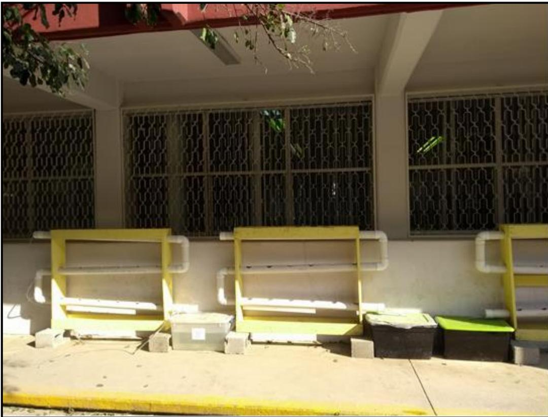
**Figura 2.2** Arreglo hidropónico para evaluar el comportamiento hiperacumulador de las plántulas de frijol en presencia de cadmio y cobre.
