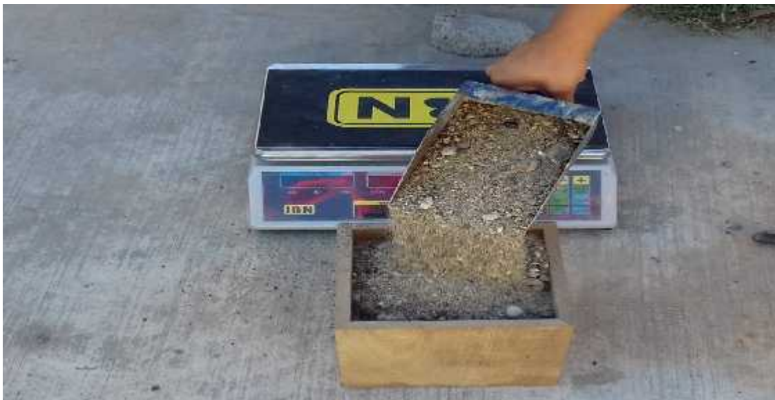
Figura 25. Peso Volumétrico Seco Varillado en gravas.
