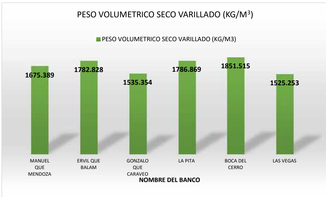
Gráfica 16. Peso volumétrico seco varillado en agregados finos.
