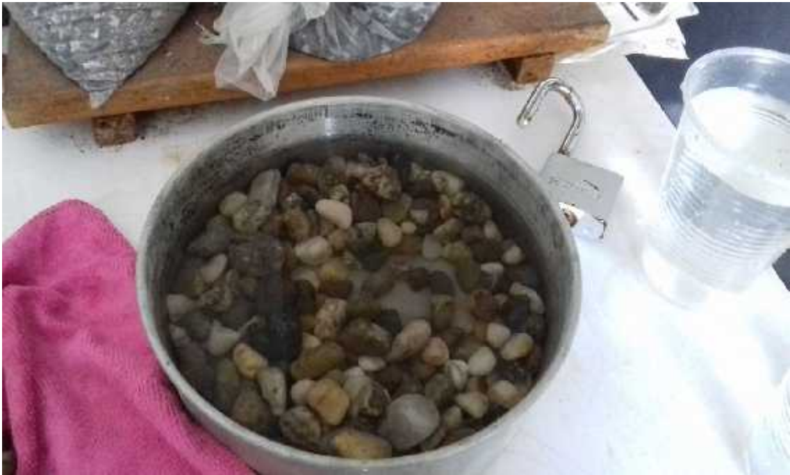
Figura 21. Muestra saturada por 24 horas en grava.
