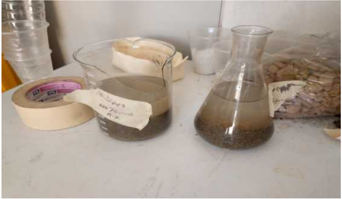
Figura 30. Saturado me material fino por 24 horas.
