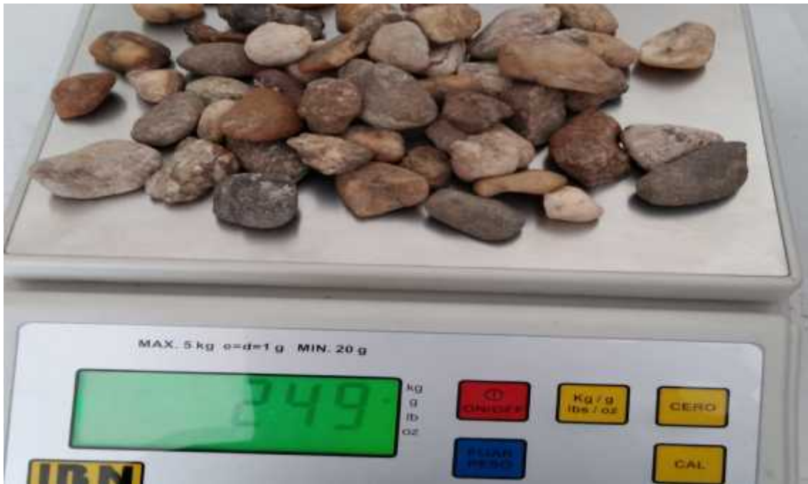
Figura 38. Pesado de material grueso semiseco para pruebas de absorción y densidad.
