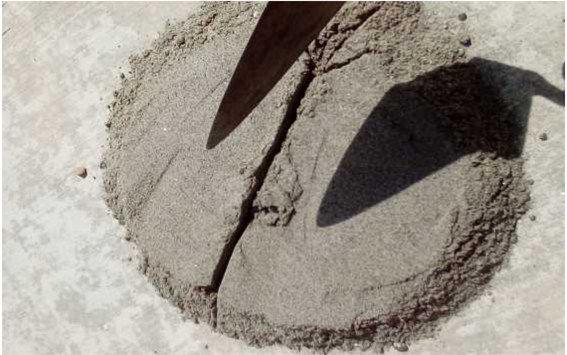
Figura 28. Método de cuarteo en una arena.
