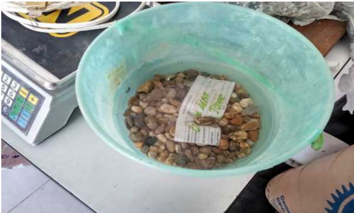
Figura 37. Saturado de material grueso por 24 horas.
