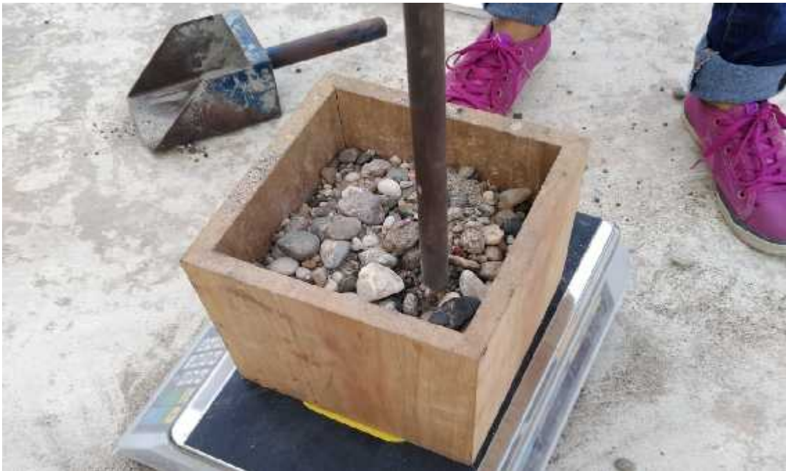
Figura 35. Método de peso volumétrico seco varillado en gravas.
