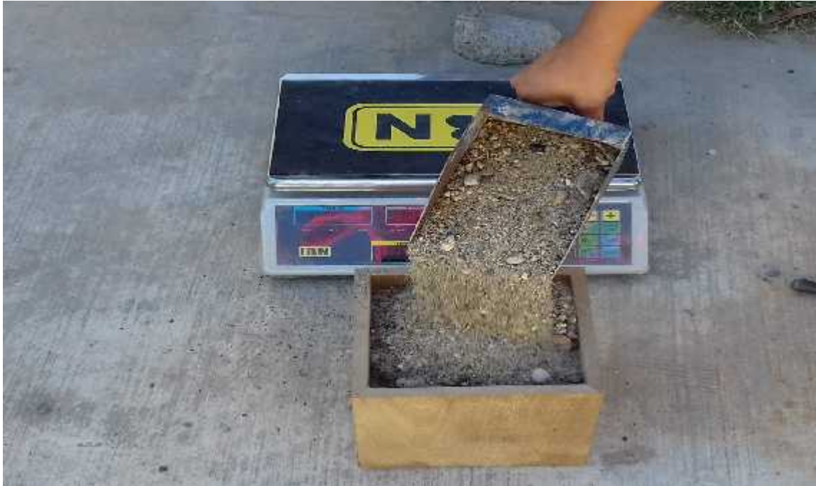
Figura 24. Peso Volumétrico Seco Suelto en gravas.
