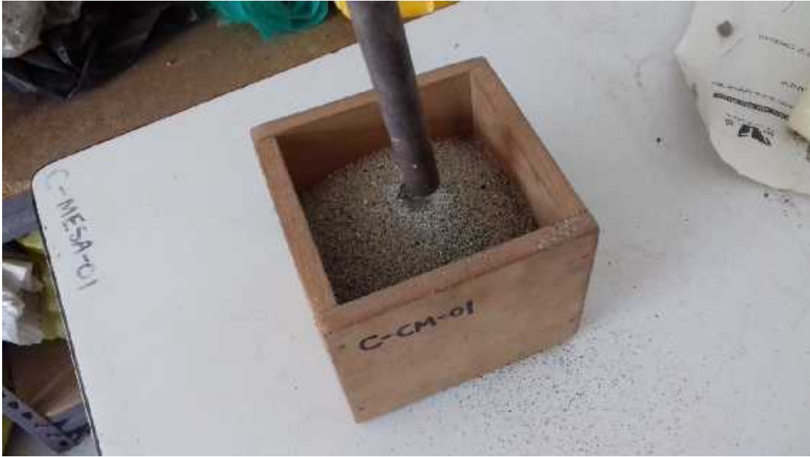
Figura 16. Método de peso volumétrico seco suelto en arena.
