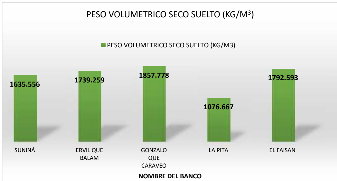
Gráfica 21. Peso Volumétrico Seco suelto en agregado grueso.
