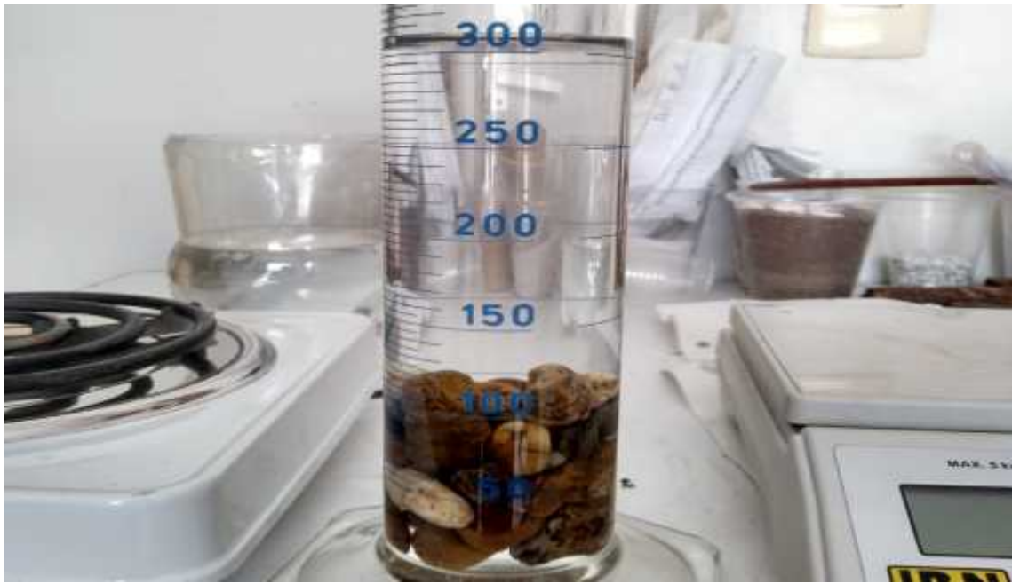
Figura 40. Prueba de densidad en material grueso.
