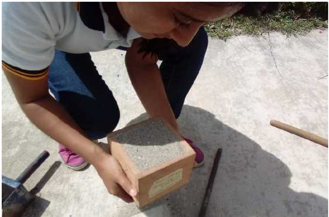
Figura 29. Método de peso volumétrico en una arena.
