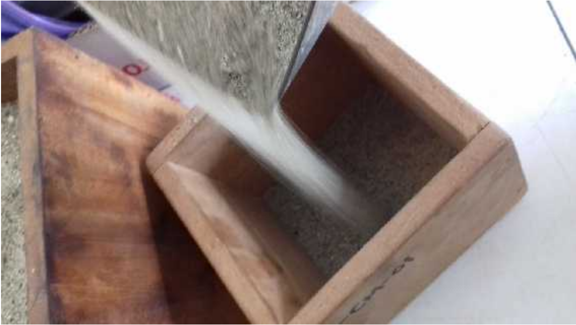
Figura 15. Método de peso volumétrico seco suelto en arena.
