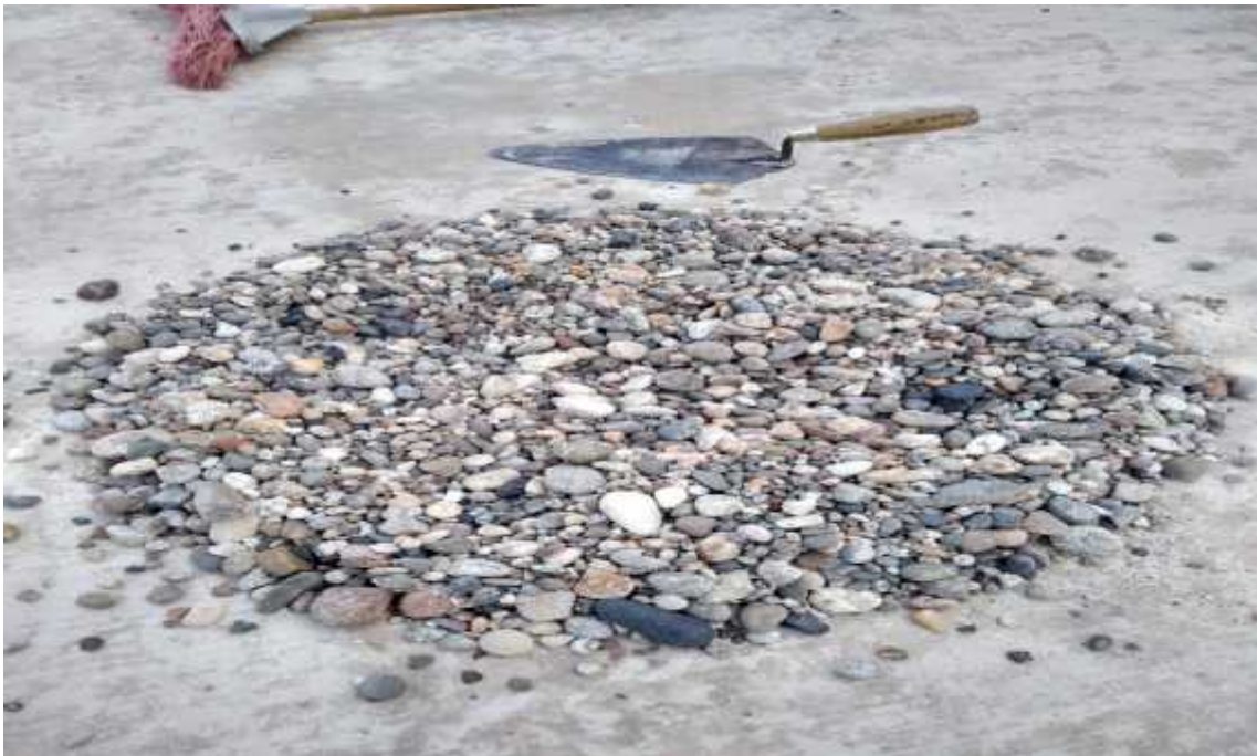
Figura 33. Método de cuarteo en gravas
