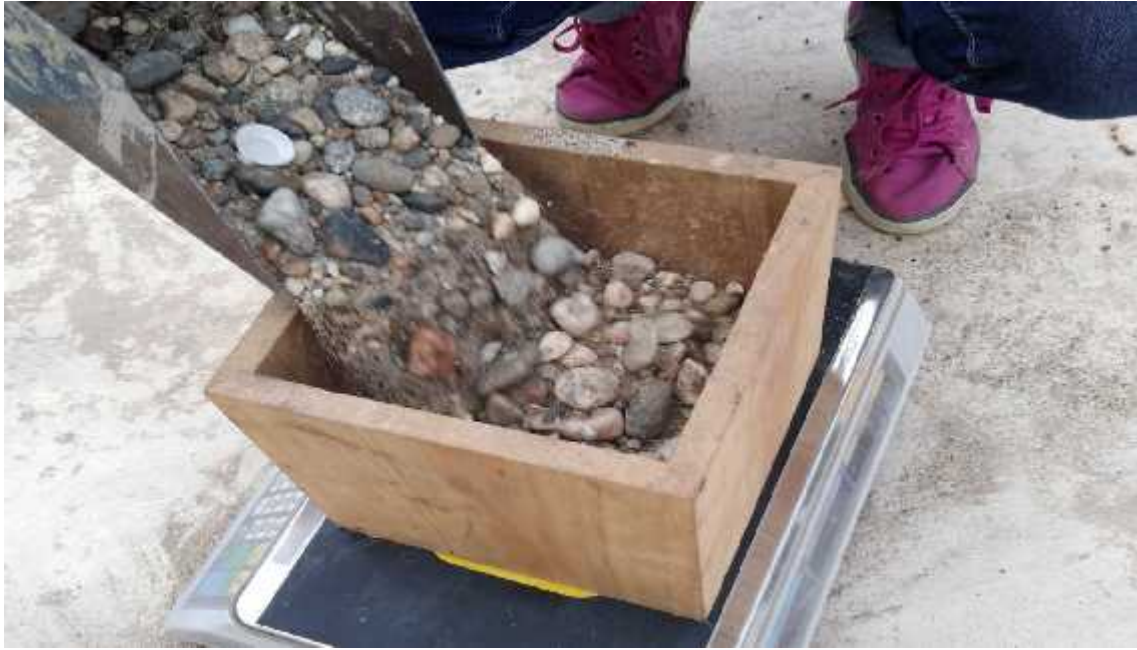
Figura 36. Método de peso volumétrico seco suelto en gravas.
