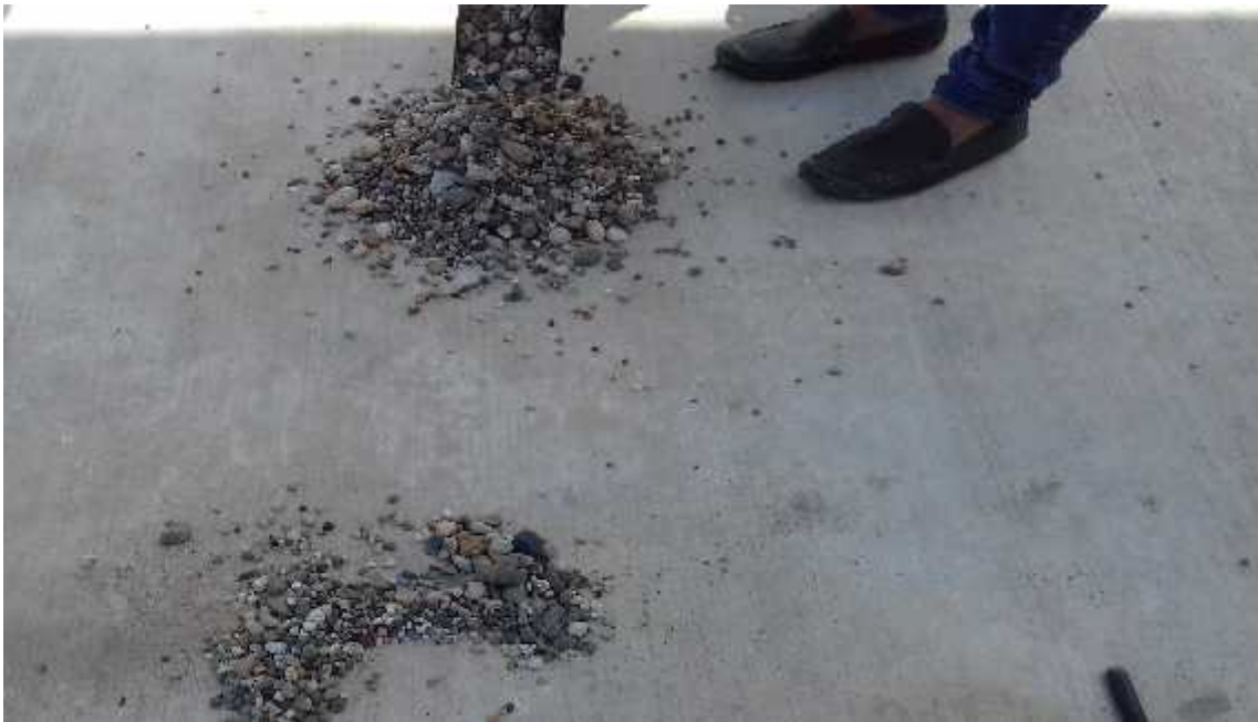
Figura 19. Método de cuarteo en gravas.
