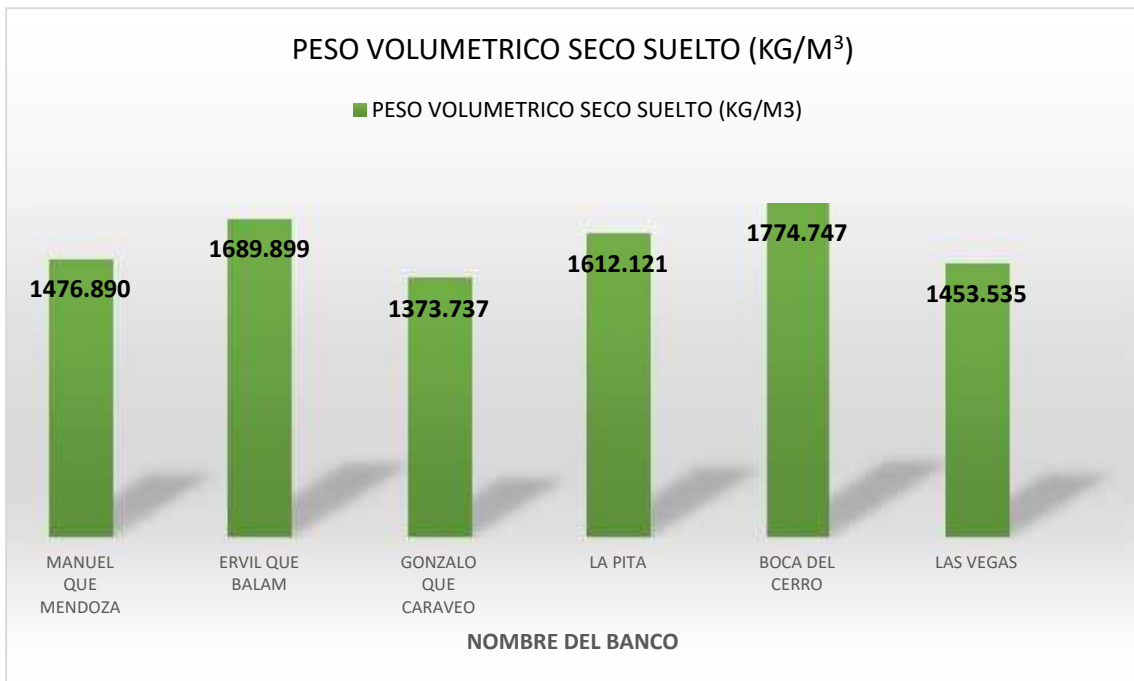
Gráfica 15. Peso volumétrico seco suelto en agregados finos.
