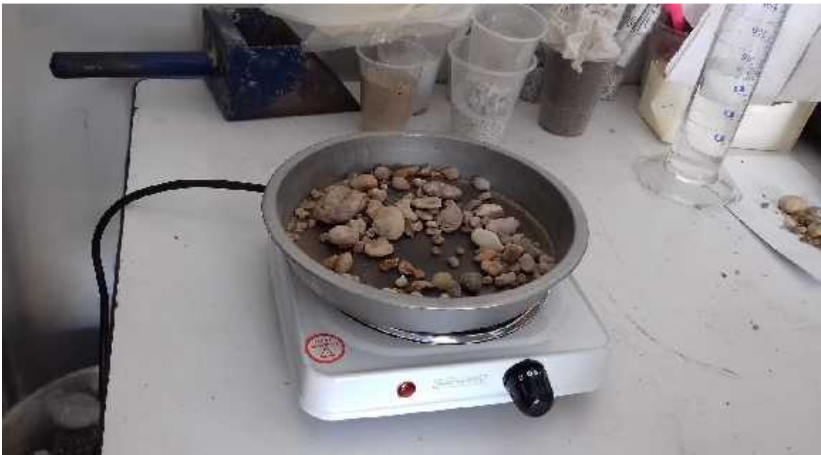
Figura 22. Muestra del material grueso secado en parrilla.
