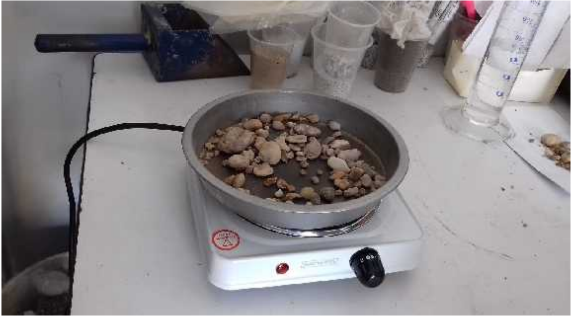
Figura 20. Humedad en gravas.
