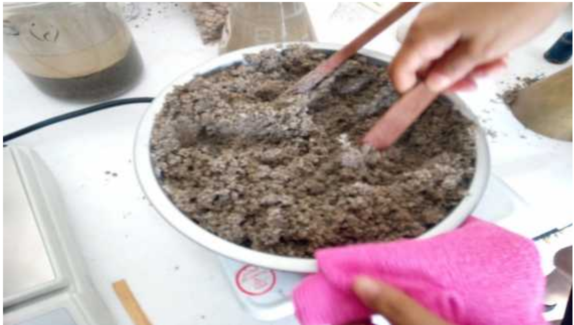
Figura 31. Semisecado de material fino en parrilla.
