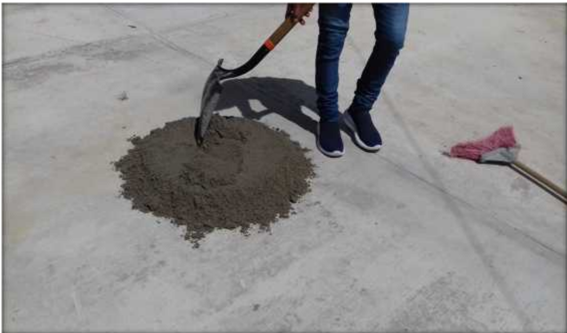
Figura 14. Método de cuarteo en arena.
