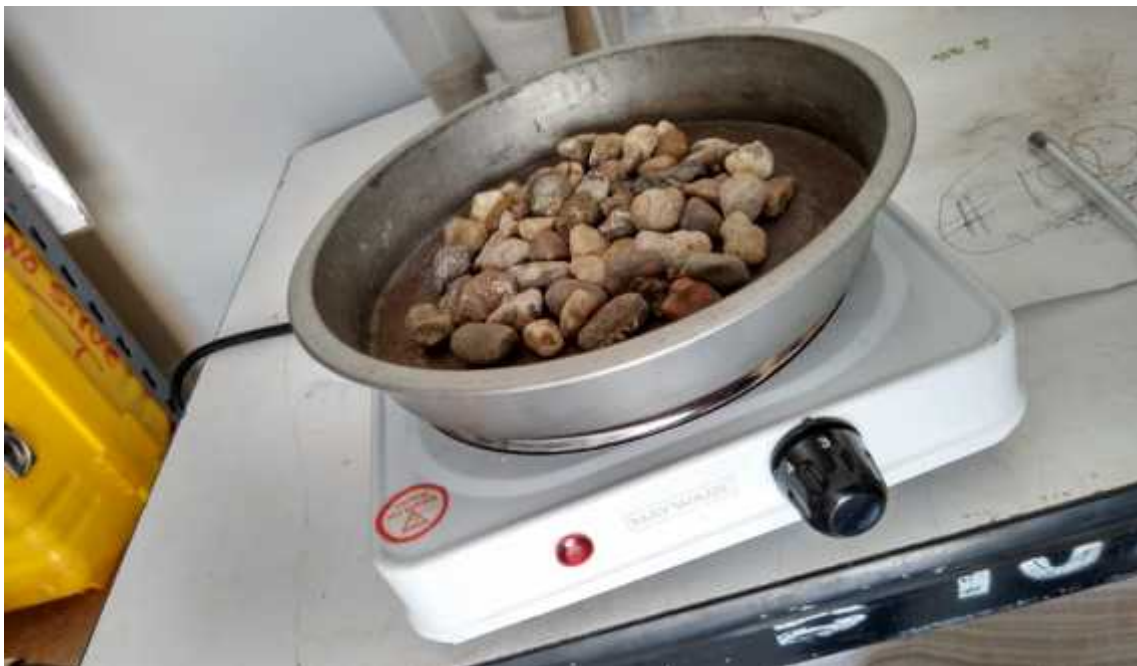
Figura 39. Prueba de absorción en agregados gruesos.
