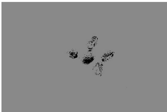
Figura 4.31: Umbral del grano con 20 horas de secado.
