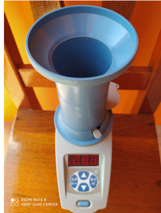
Figura 4.11: La muestra pasa a la base del dispositivo.
