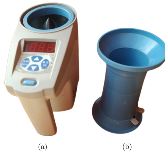
Figura 4.3: (a) Base del medidor de humedad. (b) Tubo de llenado
