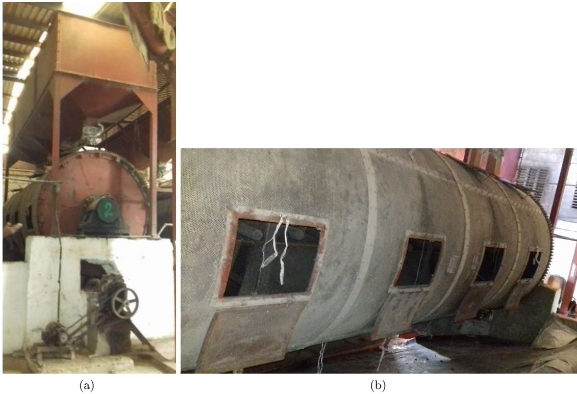
Figura 4.1: Horno mecánico: (a)Vista frontal. (b)Vista lateral.
