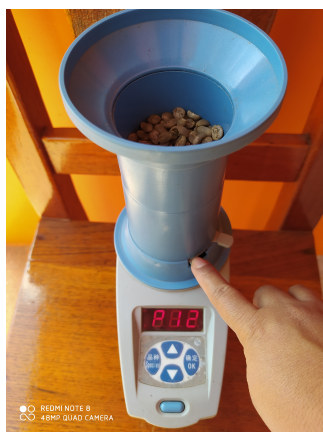
Figura 4.10: Presionando el botón de la compuerta.
