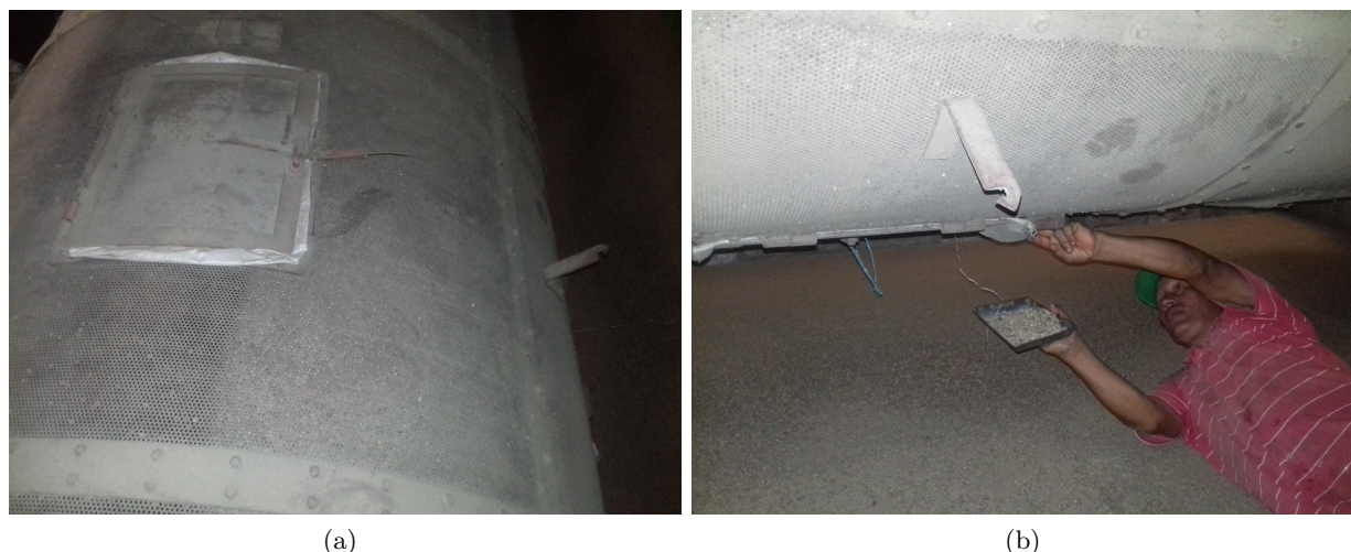
Figura 4.4: a) Escotilla. b) Extracción de una muestra.
