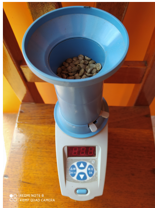
Figura 4.7: Tubo de llenado colocado en el dispositivo.
