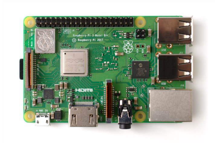
Ilustración II. 2 Apariencia real de la Raspberry PI modelo 3 B+. Placa que fue propuesta para en el diseño temprano del proyecto.
