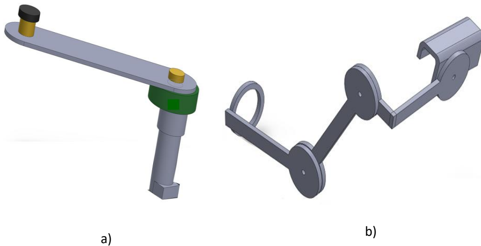
Figura 7. Tipos de robot para rehabilitación del miembro superior a) robot efector final y b) exoesqueleto
