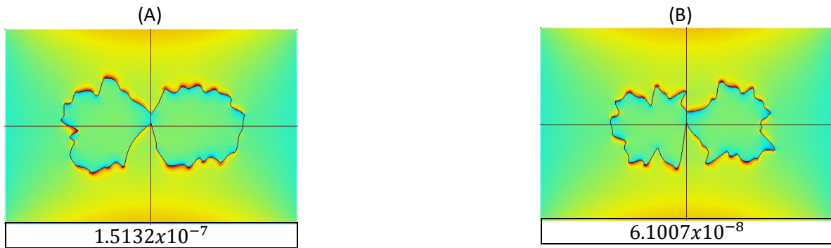
Figura 5.13 (A) par de geometrías de material oro con mayor campo eléctrico normalizado en v/m. (B) Par de geometrías de material oro con menor campo eléctrico normalizado v/m,
