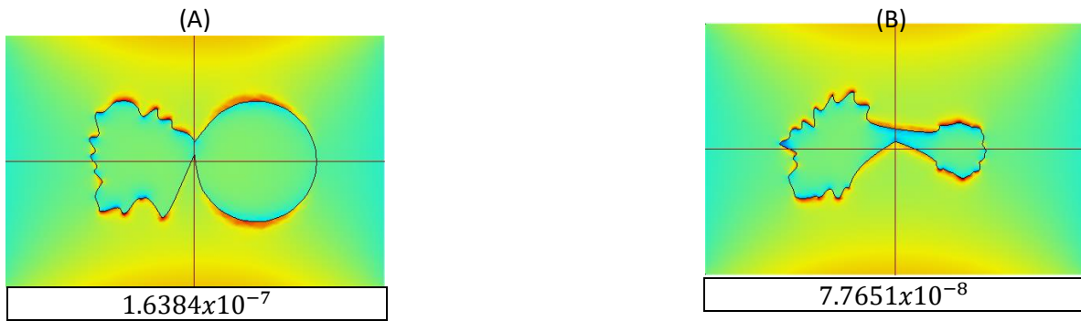
Figura 5.17 (derecha) Par de geometrías de material oro con menor campo eléctrico normalizado v/m, (izquierda) par de geometrías de material oro con mayor campo eléctrico normalizado en v/m.
