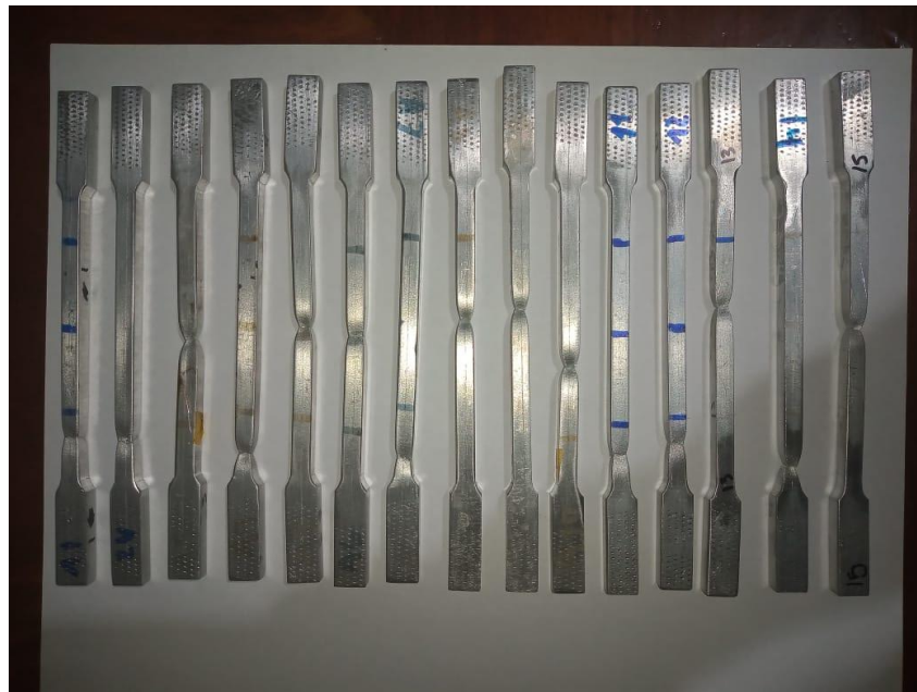
Figura 4.9. Probetas después de las pruebas de tensión
