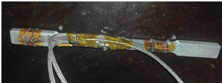
Figura 3.17. Probeta con los tres termopares sobre su superficie
