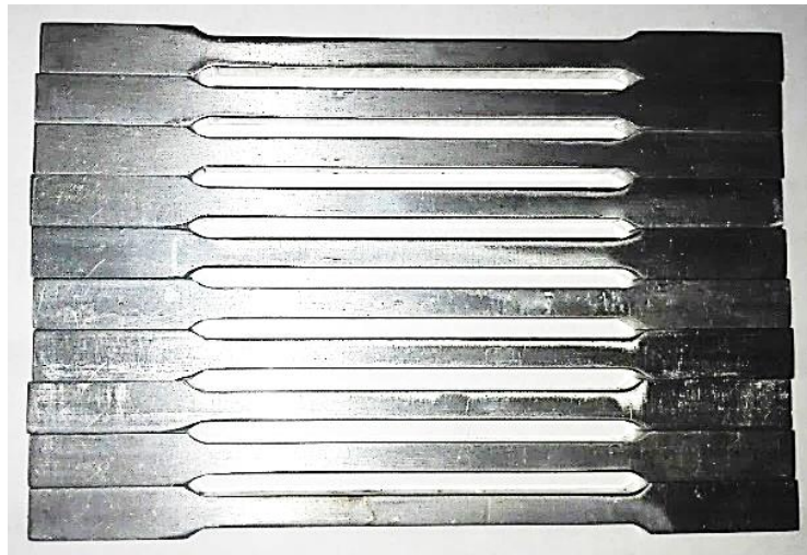
Figura 3.2: Probetas maquinadas de aluminio 6061
