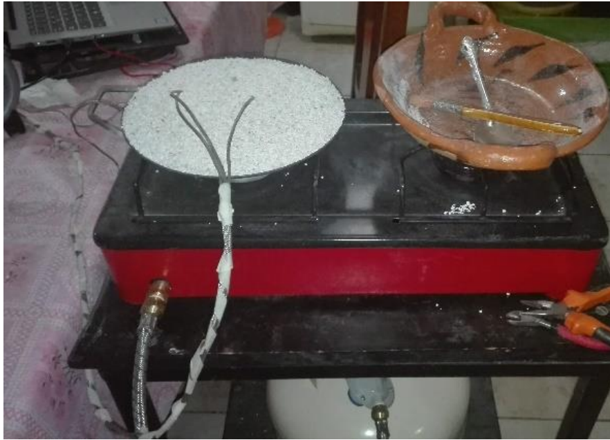
Figura 3.11: Prototipo de calentamiento mediante parrilla de gas en durante el experimento
