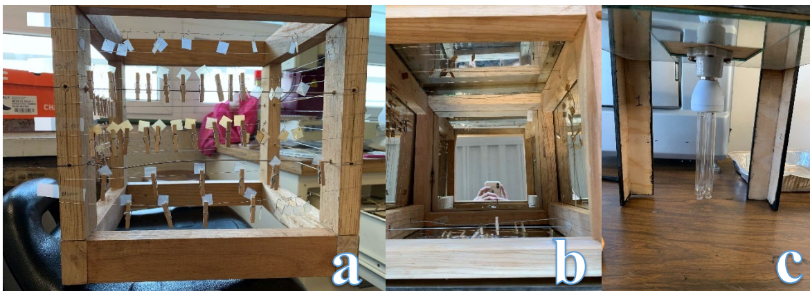
Figura 2.7 a) vista lateral de la cámara de fotodegradación, b) vista superior de la cámara de fotodegradación, c) cubierta de la cámara de fotodegradación.
