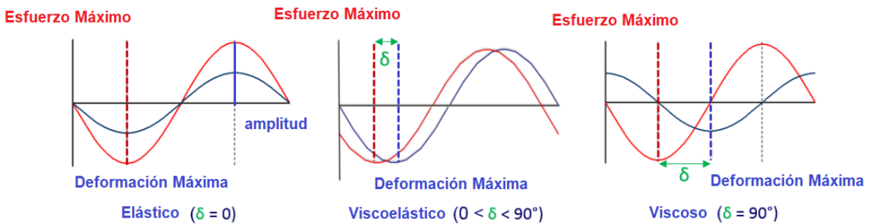
Figura 2.4 Relación entre la señal de esfuerzo y deformación para materiales puramente elástico (sólido ideal) y puramente viscoso (líquido ideal) y materiales viscoelásticos.
