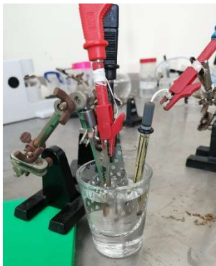
Figura 4.5. Celda electroquímica para síntesis con técnica de Cronoamperometría.
