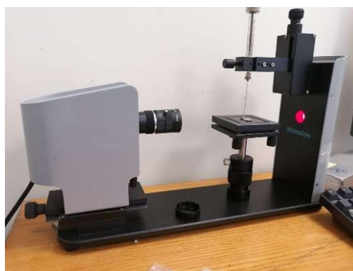
Figura 4.11. Tensiómetro óptico: equipo para la caracterización de ángulo de contacto.
