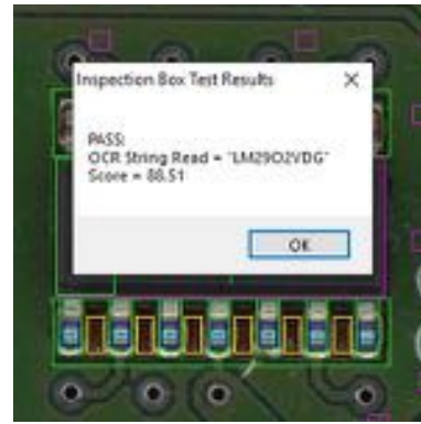
(b) Resultado de inspección por OCR.
