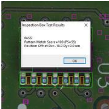
(c) Resultado de inspección por Template Matching .
