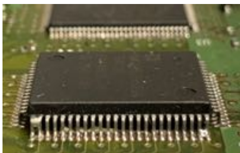
(a) Exceso de soldadura, puentes.
