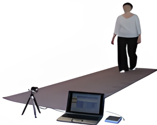
Figura 1.19: Alfombra con sensores de presión GAITRite. Obtenido de Azhand, 2021, [14].
