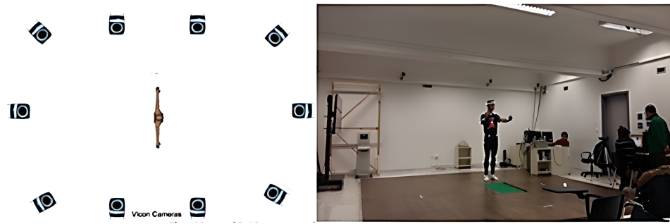
Figura 1.9: Izquierda: Topología del sistema Vicon. Derecha: Montaje del equipo de cámaras en un laboratorio. Obtenido de Voulodimos, 2018, [7].
