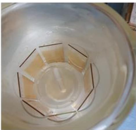
Figura 15. Vista superior del acomodo de las películas dentro del reactor.
