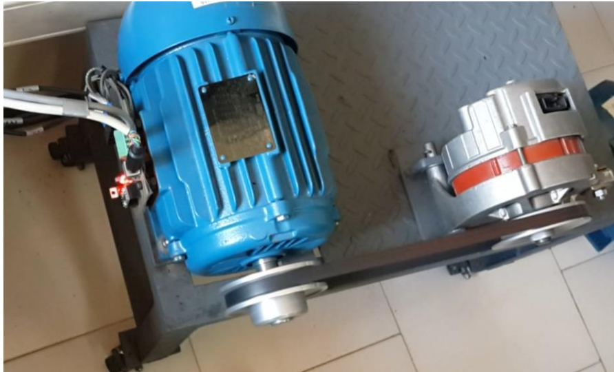
Figura 3-14 Motor de inducción en el banco de pruebas.
