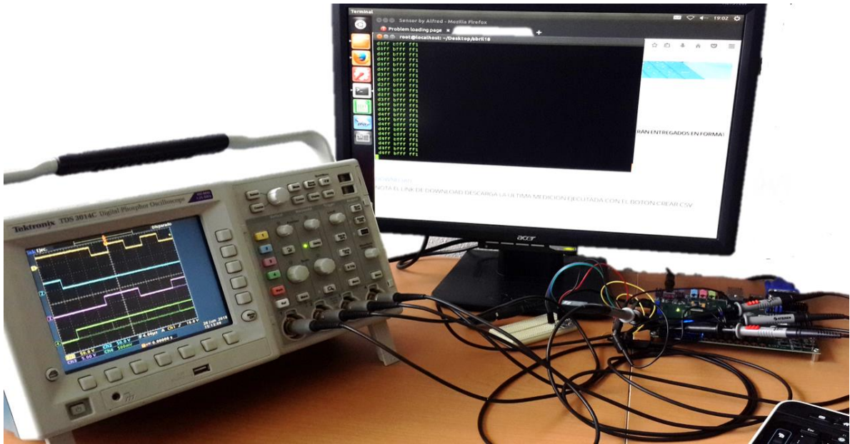
Figura 3-10 Medición de los 4 hilos de SPI.
