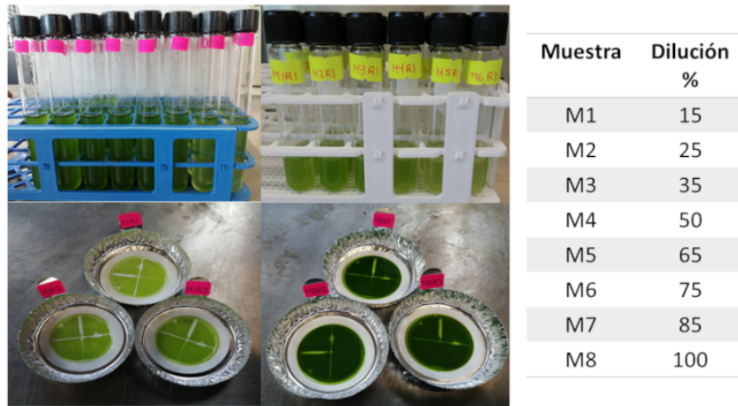
Figura 5.10: Proceso de elaboración de curva de calibración
