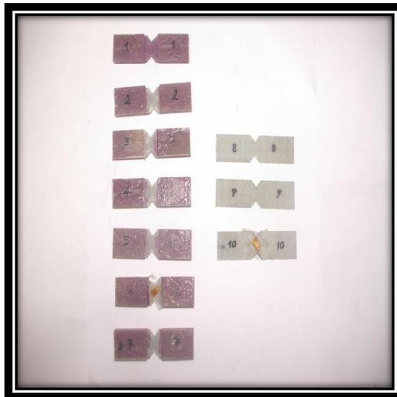
Fig. 16. Probetas Iosipescu.
