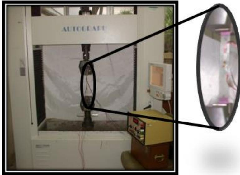
Fig. 24. Probeta con galgas extenso-métricas sometida a tensión.
