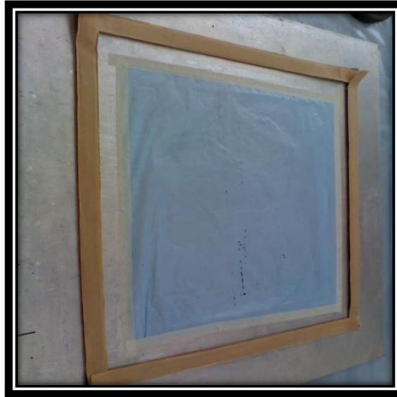
Fig. 8. Placa de trabajo con cinta adhesiva y papel teflón.
