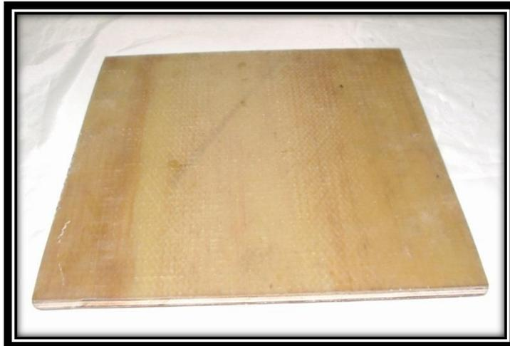
Fig. 15. Sándwich estructural de triplay.
