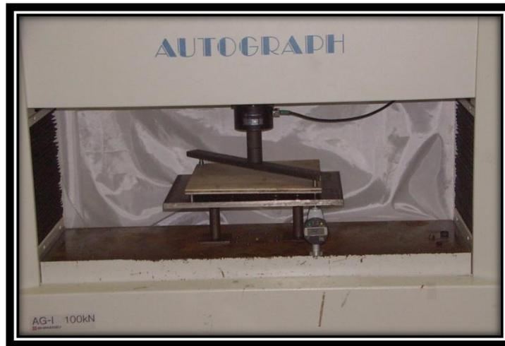
Fig. 83. Ejemplo de la prueba de torsión en sándwiches.
