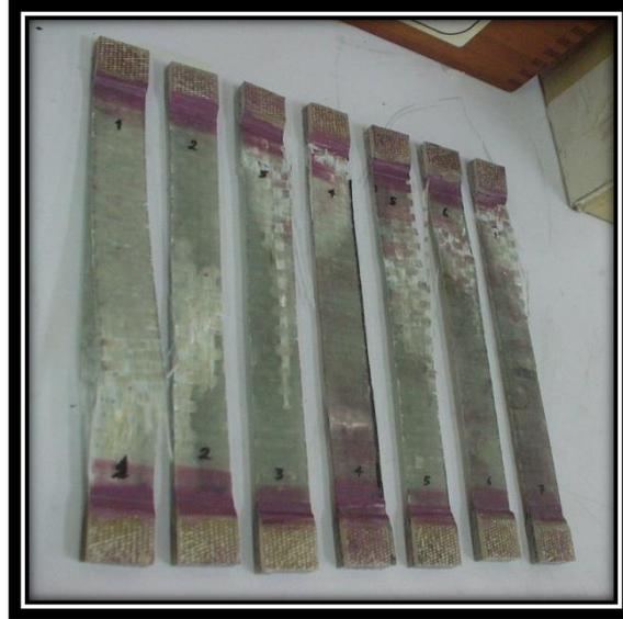
Fig. 22. Probetas para realizar la prueba de tensión.
