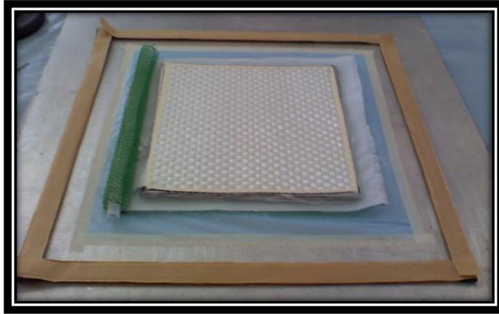
Fig. 10. Placa de trabajo con tela de teflón y 3 capas de fibra de vidrio.
