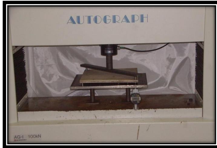
Fig. 57. Sándwich estructural de triplay sometido a la prueba de torsión.
