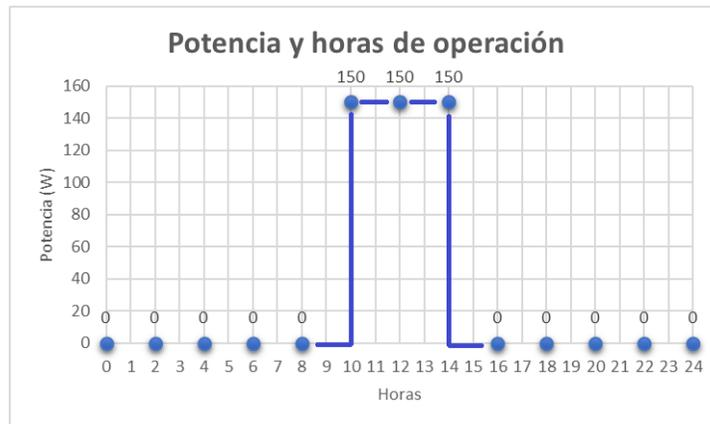
Fig. 4.4 Fases y potencia de operación.
