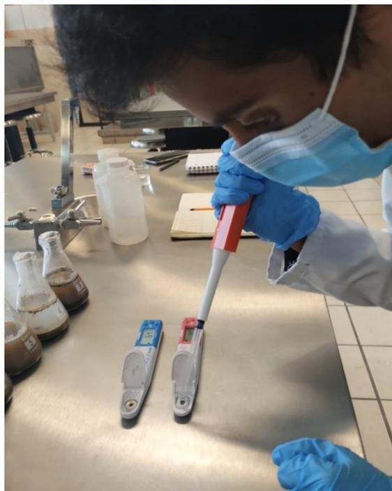
d) Aplicación de muestra de suelo al electrodo de pH y conductividad eléctrica.
