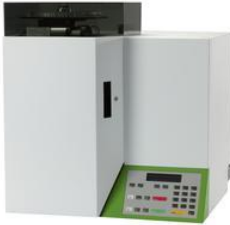
Figura 2. 9 Equipo de Análisis Elemental (CHN/O)
