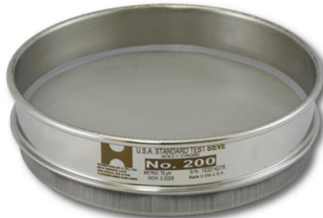
Figura 2. 3 Tamiz utilizado para la obtención del tamaño de partícula adecuado en la fibra insoluble, Marca Tyler con número de malla 200, certificado por la ASTM
