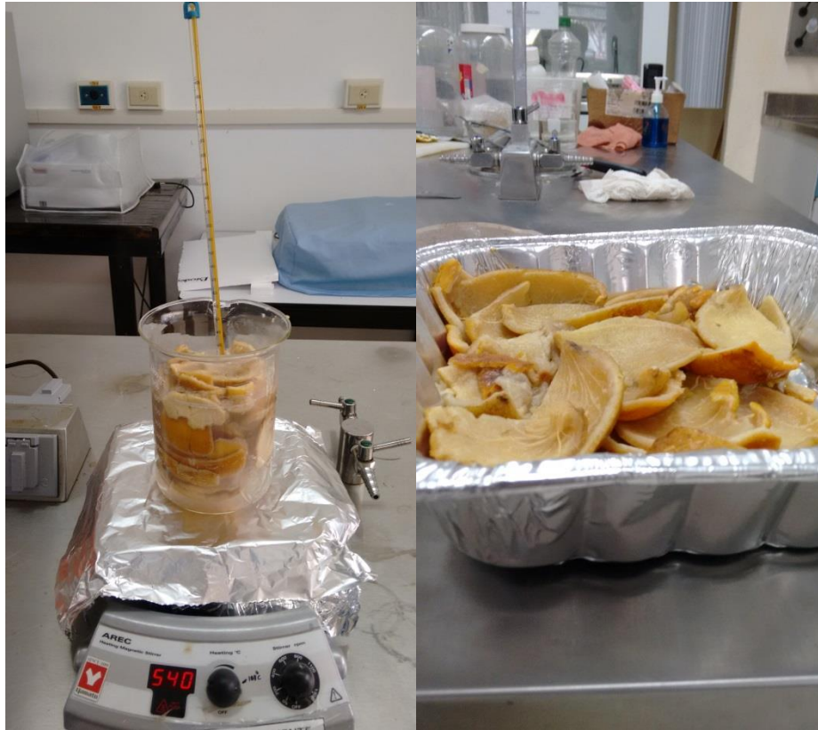
Figura 2. 2 Hidrólisis ácida en el tratamiento de la cáscara de la naranja
