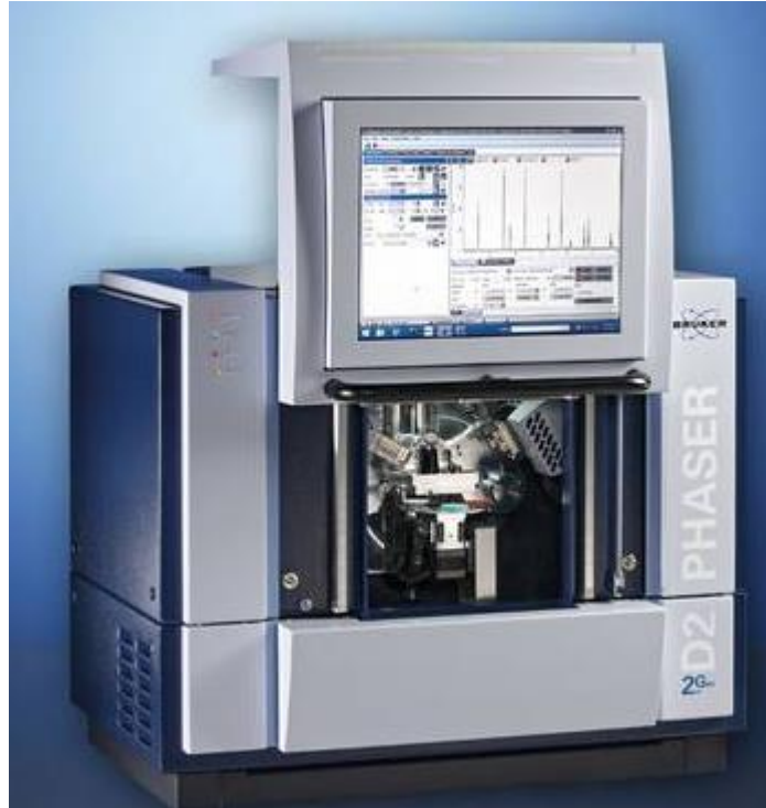
Figura 2. 13 Equipo de Difracción de rayos X Bruker
