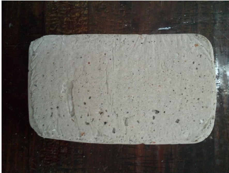
Figura 3.8 Aspecto de la muestra de bloque ecológico a partir de la formulación número 2.
