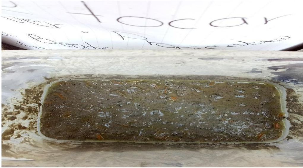
Figura 3.1 Aspecto del bloque en la primera formulación.
