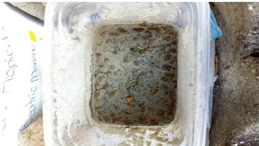
Figura 3.3. Cambios texturales en el bloque ecológico debido al tiempo de exposición al sol.
