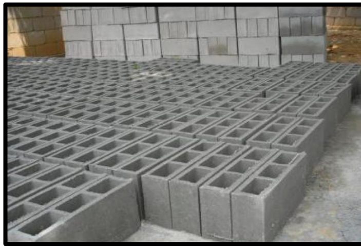
Figura 1.9 Bloques elaborados a partir de cemento.
