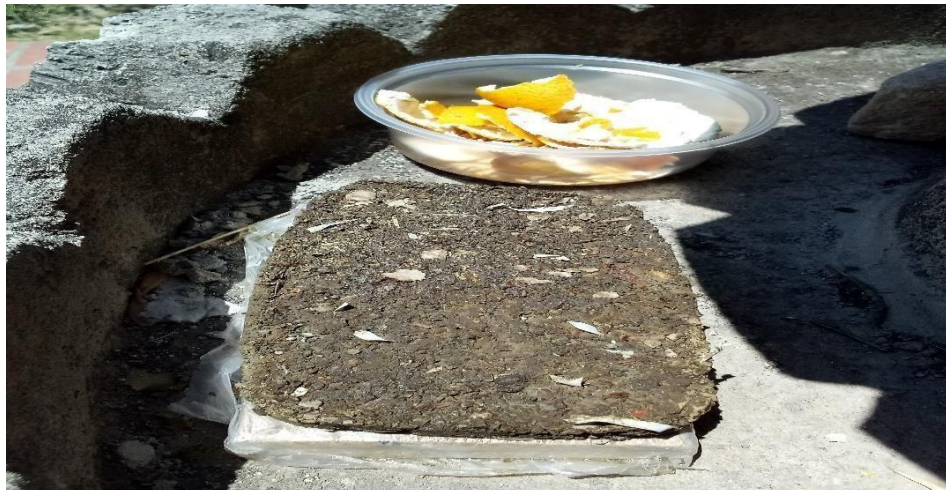
Figura 3.11 Aspecto de la muestra de bloque ecológico a partir de la formulación número 3.
