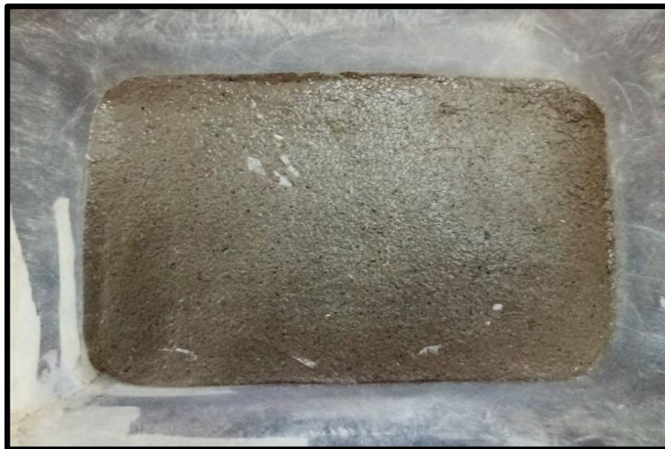
Figura 2.31 Vaciado del mortero de la formulación 4, en el recipiente.
