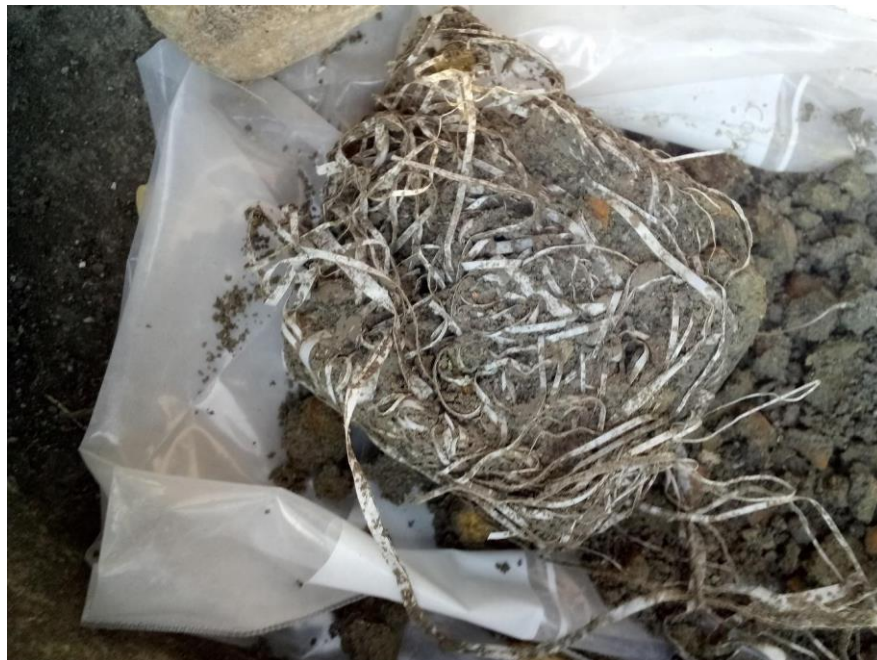
Figura 3.4 Aspecto del bloque ecológico con características deficientes.
