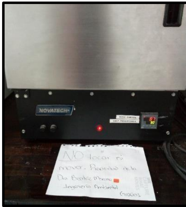
Figura 2.15 Horno a 87°C con fibra de yuca en su interior.
