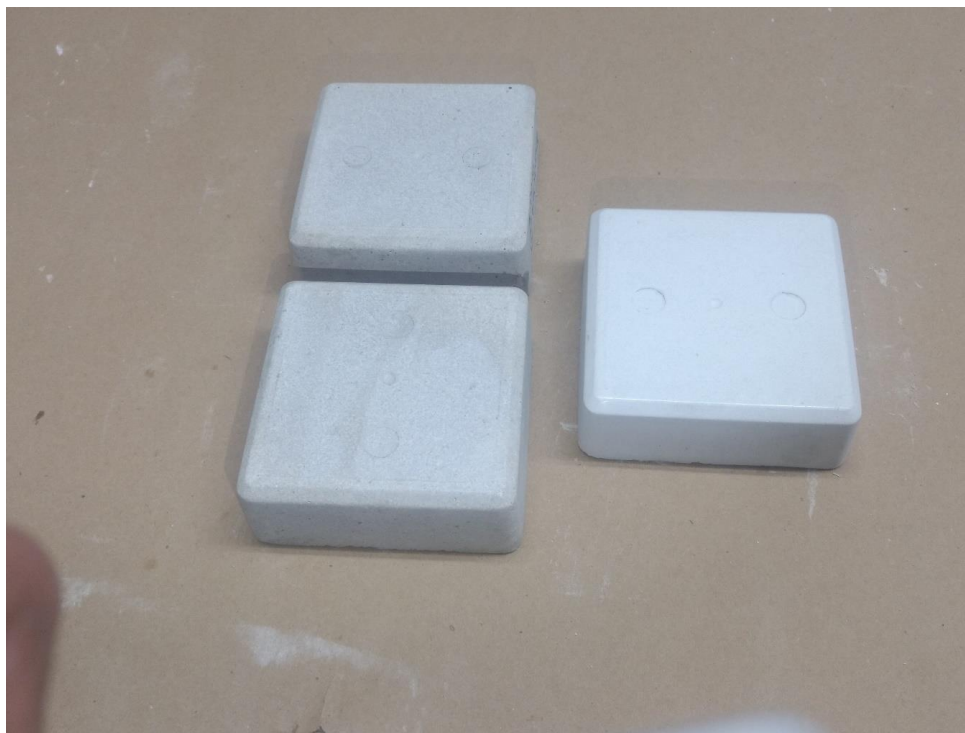
Figura 3.14. Bloque ecológico con su apariencia final, utilizando residuos fuera de norma como aditivos.
