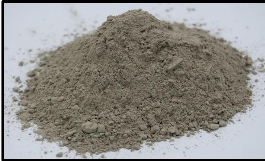
Figura 1.7 Textura y apariencia del cemento portland.
