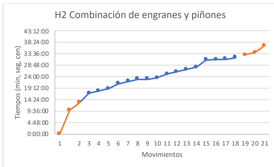
Fig. 19. Tiempos y movimientos en horno 2, con engranes en color azul y piñones en color naranja.
