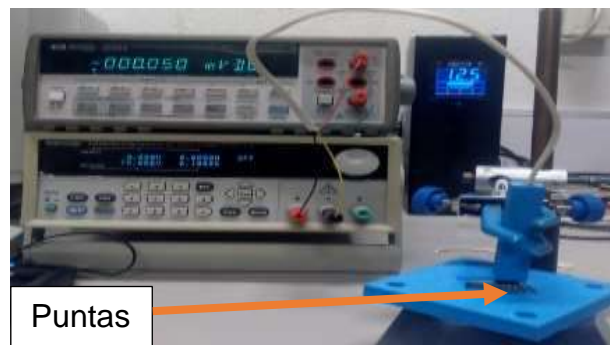
Figura 3.7. Equipo de cuatro puntas para la determinación de la resistividad.
