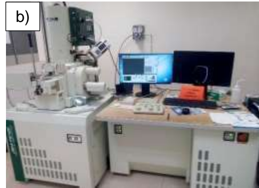
Figura 3.8. a) DETON-VACUUM. b) Equipo SEM marca JSM-7610F.
