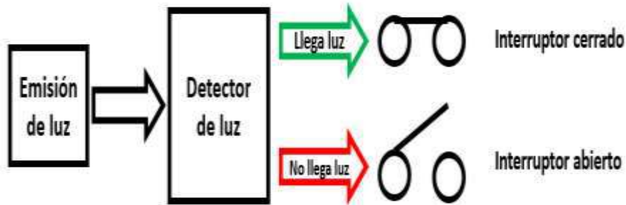
Figura 2.11. Funcionamiento básico de un optoacoplador.
