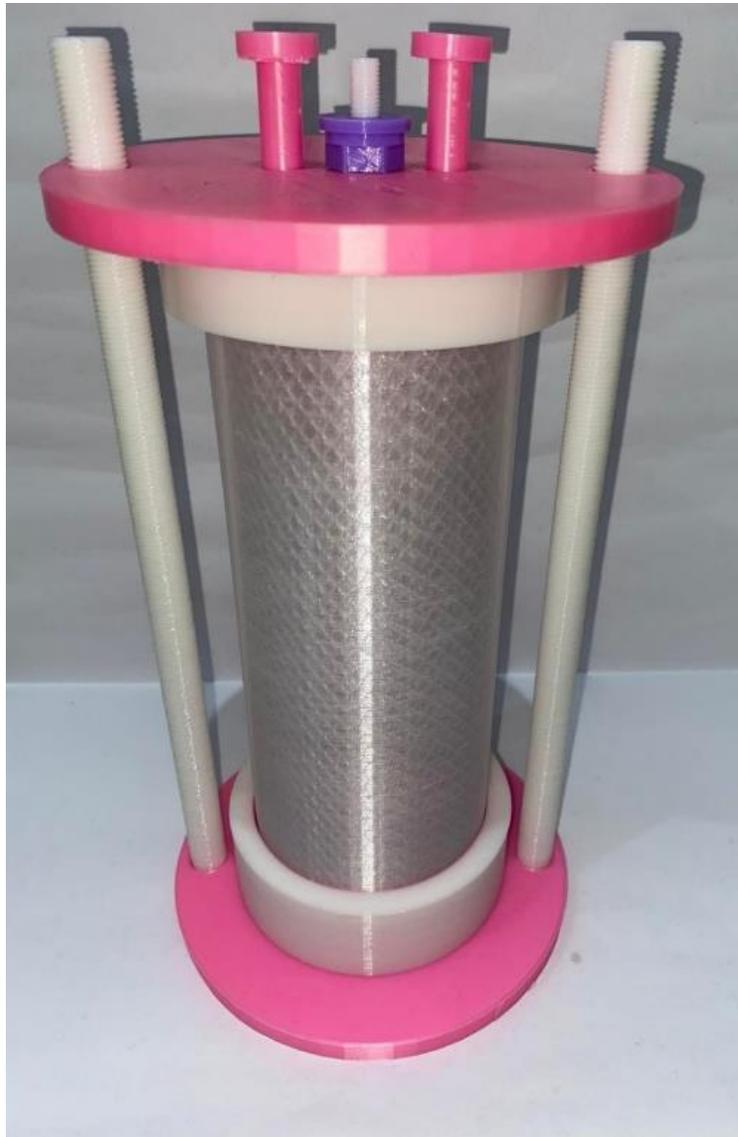
Figura 52 Foto del reactor completo, impreso en 3D, Fuente: elaboración propia.
