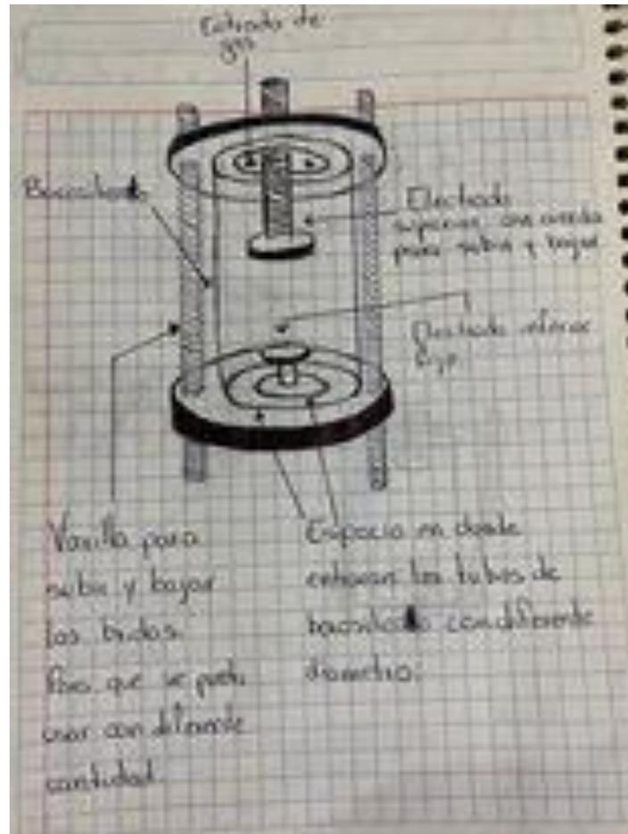
Figura 19 Boceto del reactor, Fuente: elaboración propia.
