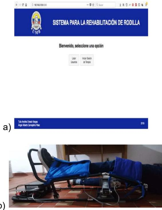
*Nota: Aplicación WEB y sistema físico de rehabilitador de rodilla. Tomado de Oviedo et al, 2018.*
