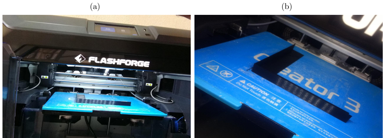
Figura 2.15: Impresión del marco para la interfaz electrónica.
