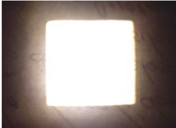
Figura 2.10: Píxel utilizando la rejilla (evita la dispersión del brillo).
