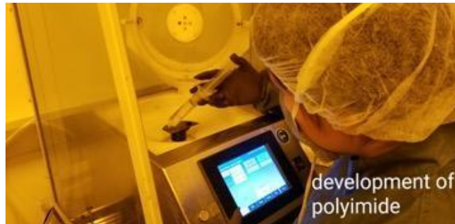
Imagen 21.-Develado de Polymide con los reveladores QZ y SU8
