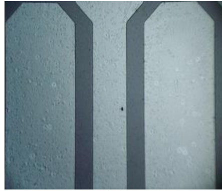
Imagen 37.-Bump Pads con metal (Ti/Pt)
