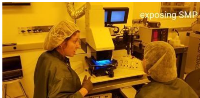
Imagen 19.-Máquina de alineamiento de máscara con la oblea y exposición UV
