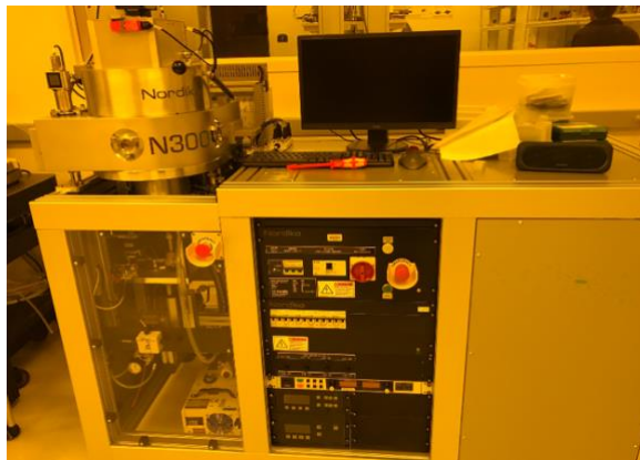
Imagen 11.-Máquina de deposición de metal (Metal Deposition) Nordiko
