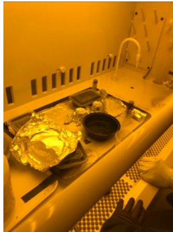
Imagen 60.-Proceso de separación de la oblea y los dispositivos por medio de BHF
