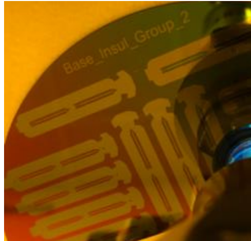
Imagen 47.-Oblea con la primera capa (electrodos glassy carbon)
