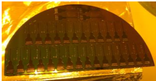
Imagen 40.-Oblea con las seis capas, antes del proceso de liberación con BHF
