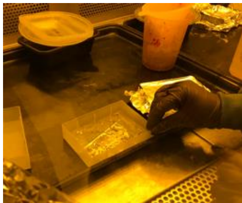
Imagen 61.-Eliminación de la capa sacrificial con ayuda de acetona
