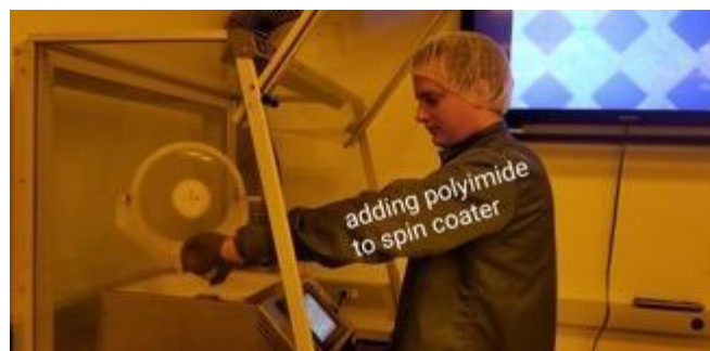
Imagen 20.-Proceso de centrifugado en la nueva máquina (new spin coater) aplicando el sustrato Polymide
