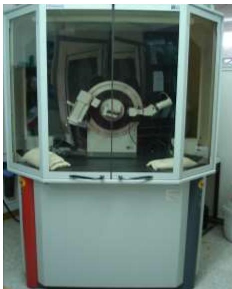
Figura A- 1 Difractómetro marca BRUKER AXS modelo D8000 ADVANCE
