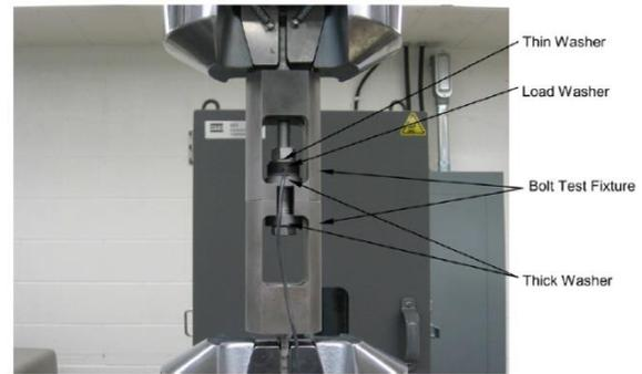
Fig. 2. 13 Ensamble de la unión emperrada para el análisis experimental [13].
