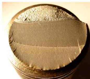
Fig. 2. 39 Fractura por fatiga de un perno M24x3 clase 8.8. Presenta marcas de inicio a lo largo del radio de la cuerda, fractura plana con marcas de playa seguida finalmente por la fractura rugosa [4].
