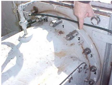
Fig. 2. 38 Unión tipo brida de un compresor de gas sometida a un estudio de fatiga. Muestra los pernos numerados [4].
