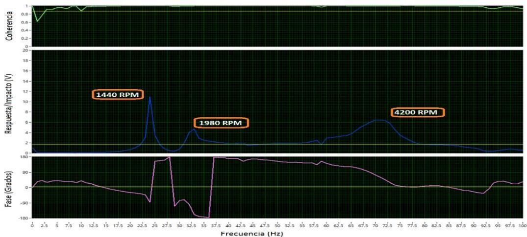
Figura 7.1.31 FRF's  $k_{\xi}$ , Rotor Asimétrico con Soporte Móvil, Posición 1.
