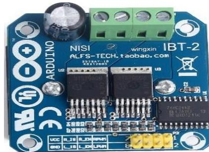
Figura C 7 Módulo Puente H BTS 7960.
