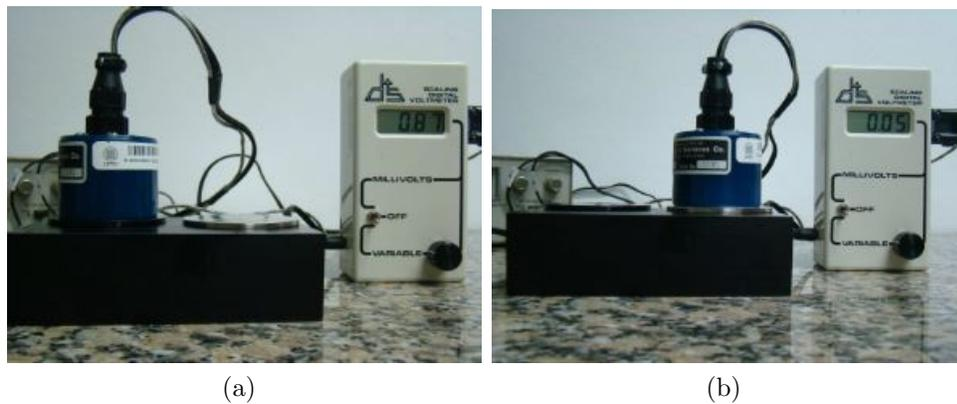
Figura 3.14: Ubicación de los patrones de alta y baja emitancia sobre el disipador.
