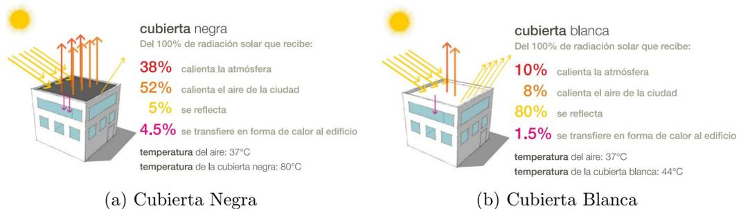
Figura 2.4: Efecto albedo para un edificio con un recubrimiento negro y blanco.
