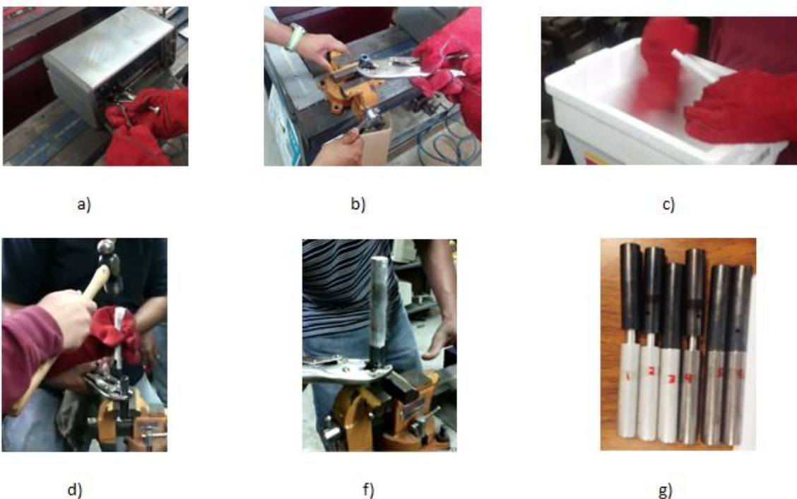
Figura 4. 12 Ensamble de la unión eje-cubo, donde: a) tomar del horno eléctrico el cubo con las pinzas de presión, b) sujetar el cubo en el tornillo de banco, c) extraer del recipiente aislante el eje con los guantes de carnaza, d) posicionar el eje y realizar el ensamble con un impacto del martillo, f) unión eje-cubo realizada, g) todas las uniones eje-cubo hechas.
