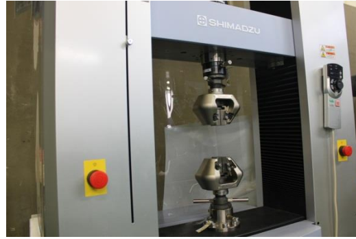
Figura 4. 14 Máquina universal Shimadzu AG-X plus con el equipo para la prueba de tensión.
