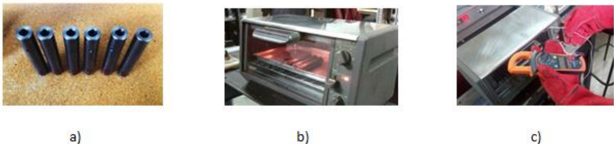
Figura 4. 11 Dilatación de los cubos, donde: a) cubos a temperatura ambiente ( 26^\circ C ), b) horno eléctrico a 250^\circ C , c) medición de la temperatura de los cubos con el termopar obteniéndose 230^\circ C .
