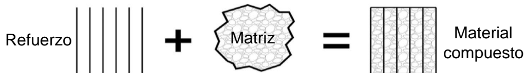
Figura 1.3. Configuración básica de los materiales compuestos [38].
