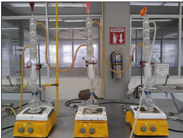
Figura 16. Determinación de grasa (Método Soxhlet). Anahi Colio (2021)
