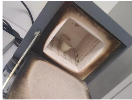
Figura 24: Determinación de cenizas. Anahí Colio (2021)
