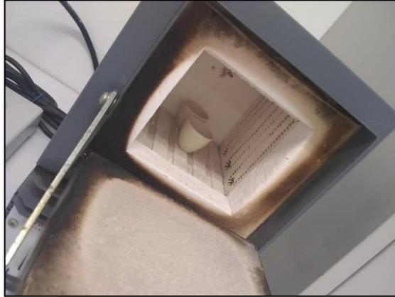
Figura 13. Determinación de cenizas. Anahi Colio (2021)
