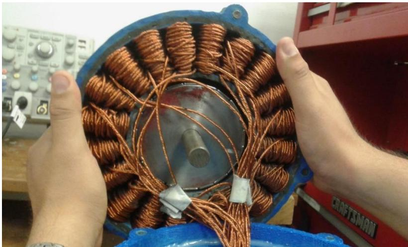
*Figura 42. Embobinado del estator.*
