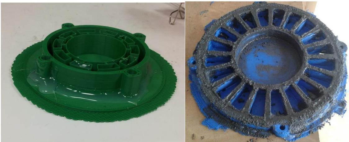
*Figura 38. Diseño físico de los moldes de los generadores en la impresora 3D*
