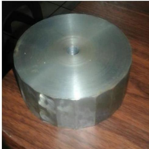
*Figura 41. Rotor de 20 polos.*
