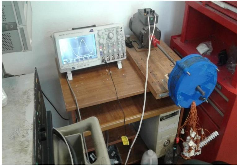
*Figura 47. Banco de pruebas del generador de 20 polos*
