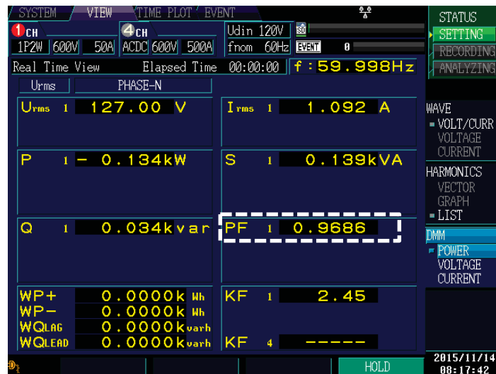
Figura 3.8. FP obtenido en pruebas experimentales por el medidor de la calidad de energía.
