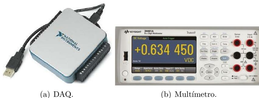
Figura 5.1: DAQ y multímetro utilizado para comparar los registros realizados con el dispositivo.
