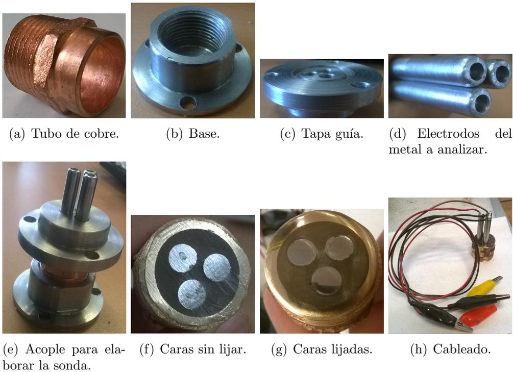
Figura C.2: Elaboración de una sonda de medición de ruido electroquímico para un equipo.
