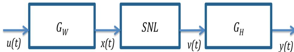
Figura 1.1: Modelo de identificación no lineal Wiener-Hammerstein.
