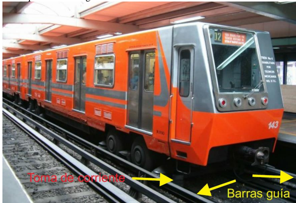
Figura 2.9: Ubicación de las barras guía en la vía del tren.
