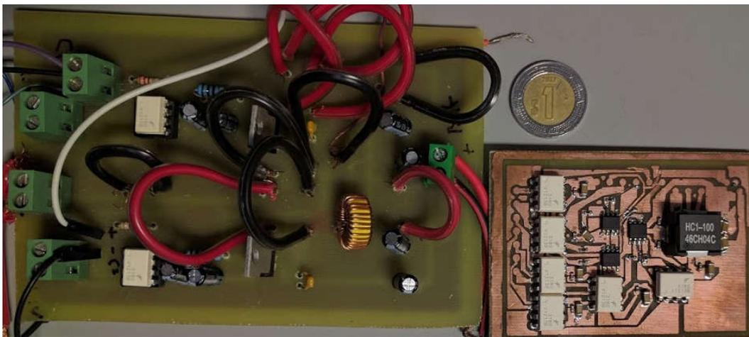
*Figura 5.5.2* Del lado izquierdo se puede observar el primer prototipo de accionador, mientras que del lado derecho se puede observar el prototipo final (segundo prototipo) del accionador.
