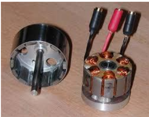
Fig. 4.1. Motor BL-DC, a) BLCD tipo outrunner y b) Corriente y voltaje
